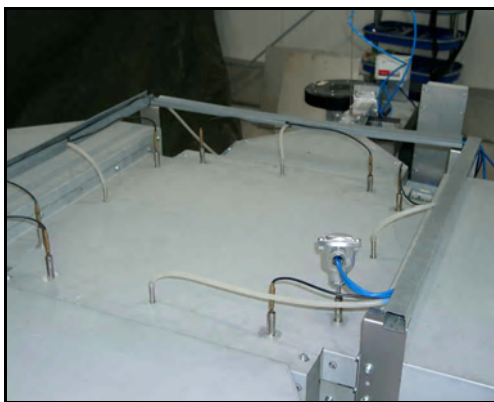
B Testbereich mit den Temperatur und Drucksensoren
