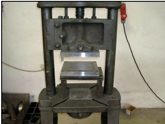
Abb. 37 Presse mit Stempel - Frontsicht
