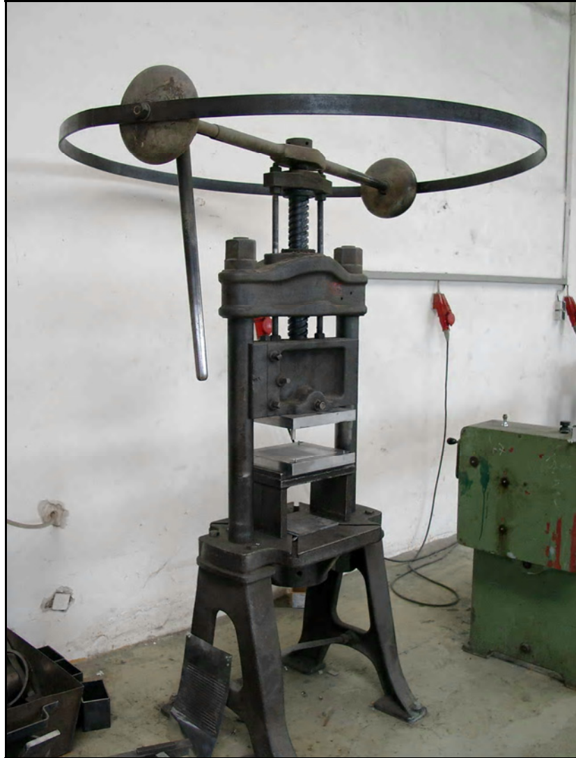
Abb. 36 Presse mit Stempel - Seitenansicht
