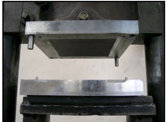
Abb. 38 Stempel – Obere Platte
