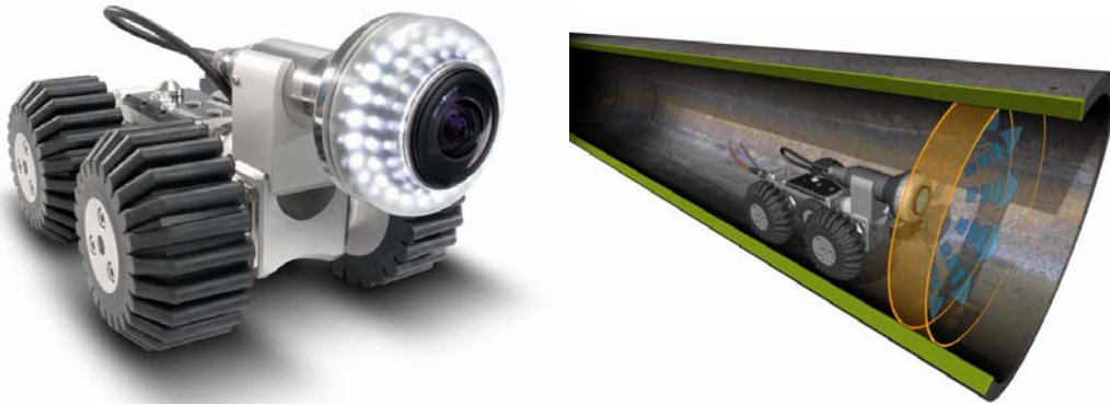
Bild 2-3: DigiSewer: Kamerasystem auf iPEK Trägersystem (links), Funktionsschema (rechts); (Quelle: iPEK Spezial-TV GmbH & Co KG)
