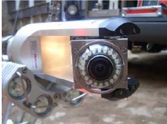
Bild 2-7: Darstellung des Fisheye-Objektives der RPP® DuoVision mit gegenüberliegendem optischen 10fach-Zoom-Objektiv (Quelle: Fa. RICO EAB, Kempten)
