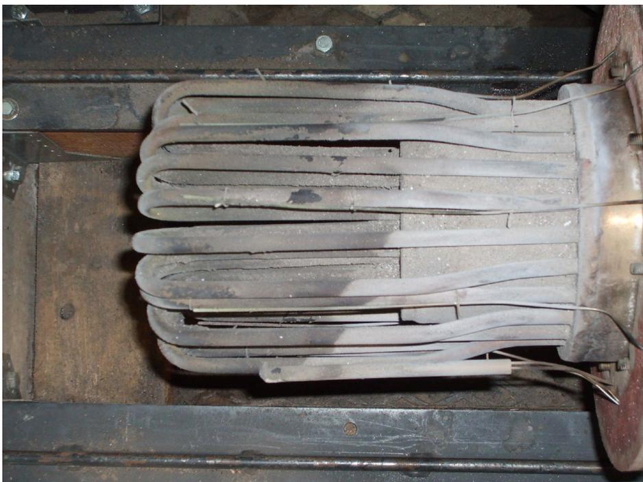
Abbildung 5: Hairpin-Erhitzer nach 100 Stunden – Anlage 3 (Stückholz)
