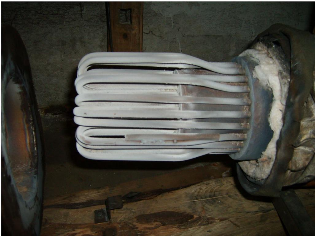
Abbildung 6: Hairpin-Erhitzer nach 100 Stunden Betriebszeit - Hobelsteuerung
