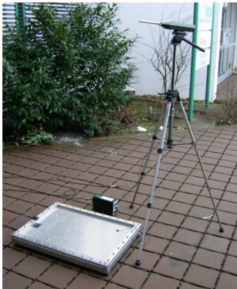
Abbildung 69: Messung des Schalldruckpegels über der Platte
