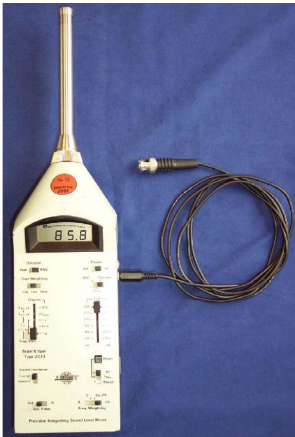
Abbildung 3: Der Schallpegelmesser B&K Type 2233 mit dem benutzten AC-Ausgang
