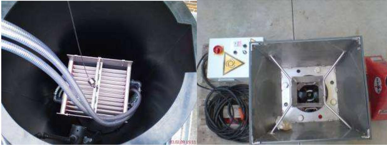
Abbildung 8-2: Modulturm (li.) und Fußhalterung mit Strömungspumpe (re.)
