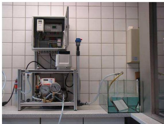
Abbildung 6-13: Versuchsanlage Reinwasserpermeabilität
