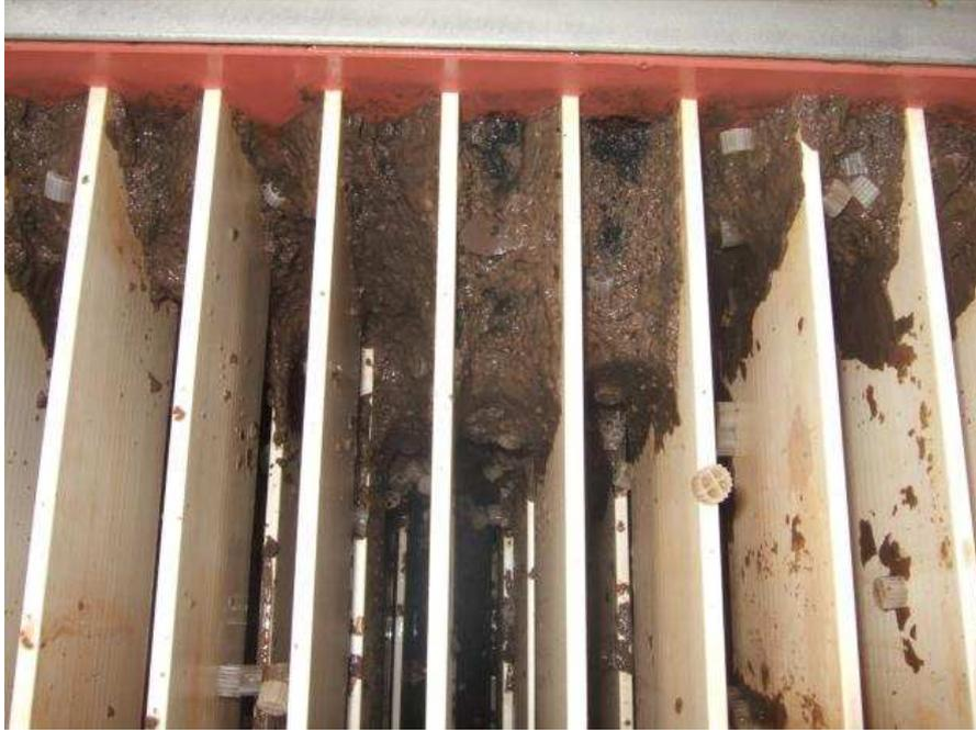
Abbildung 7-16: Verengung des Strömungsquerschnitts im Modul nach Ende der Versuchsphase
