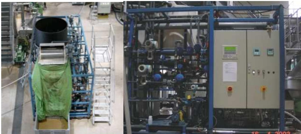
Abbildung 7-2: Versuchsanlage im bisherigen Zustand Links: Anlage mit aufgebautem Spaltrummelsieb, Rechts: Steuereinrichtung der SPS
