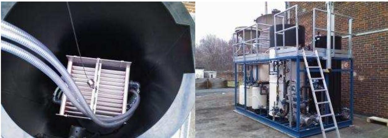
Abbildung 7-4: Links: Filtrationsreaktor mit eingebautem Modulstapel 5 Stk. á 1,4m<sup>2</sup>, Rechts: Ansicht der Versuchsanlage mit Filtrationsreaktor
