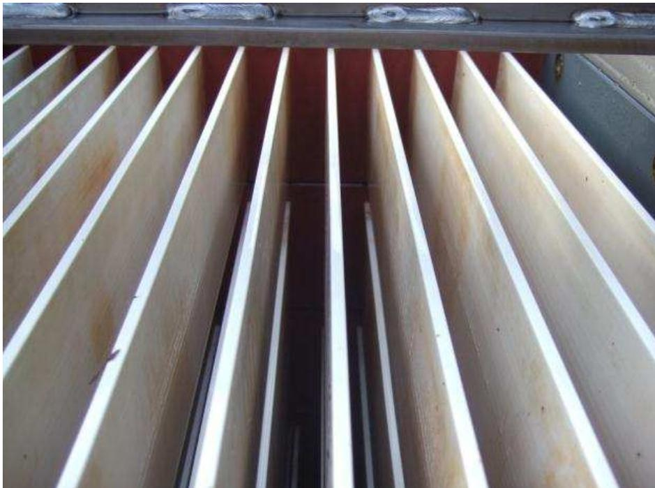
Abbildung 7-17: Reinigungserfolg durch Niederdruck-Wasserreinigung nach Versuchsende
