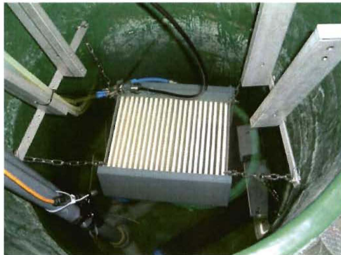
Abbildung 6-24: Versuchsanlage Sterilfiltration von Flaschenwaschwasser mit Filtrationsbehälter
