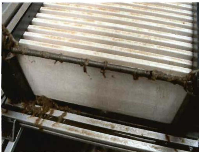
Abbildung 6-7: kommunaler Bereich, Modul nach Versuche mit Verzopfungen
