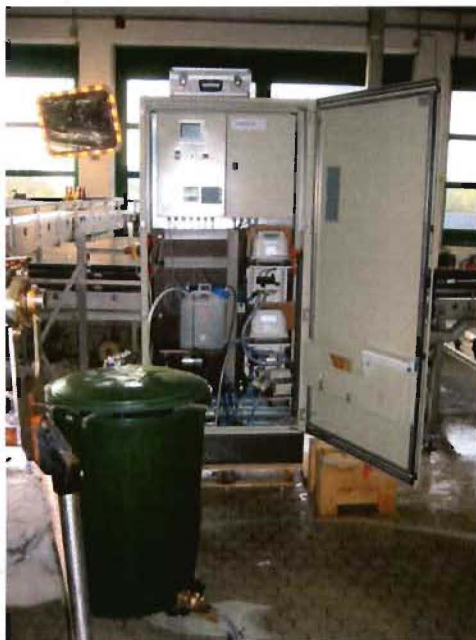
Abbildung 6-24: Versuchsanlage Sterilfiltration von Flaschenwaschwasser mit Filtrationsbehälter
