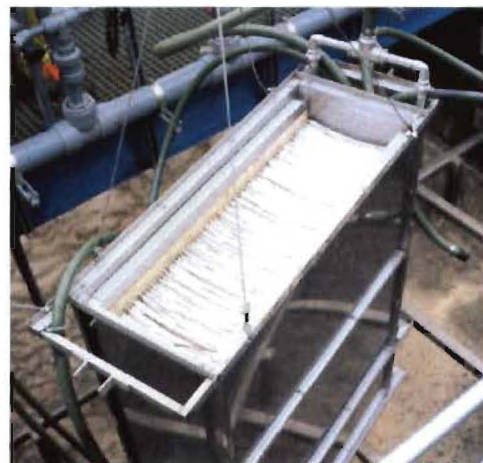
Abbildung 3-6: Hohlfasermembranmodul der Firma Mitsubishi [Firmenprospekt]
