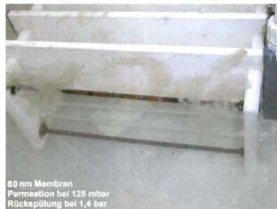
Abbildung 7-3: Deckschichtablösung einer 80 nm Membran bei einer Rückspülung mit 1,4 bar
