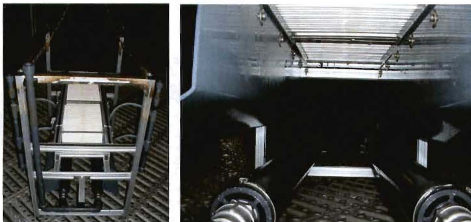
Abbildung 6-3: Rack mit zwei Minimodulen sowie der Belüftungseinheit
