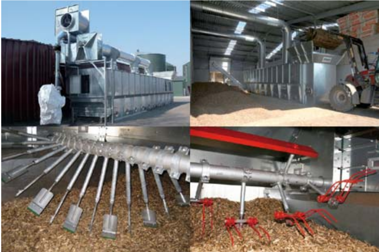
Abbildung 5-15: Darstellung eines Schub-Wende-Trockners der Fa. Riela
