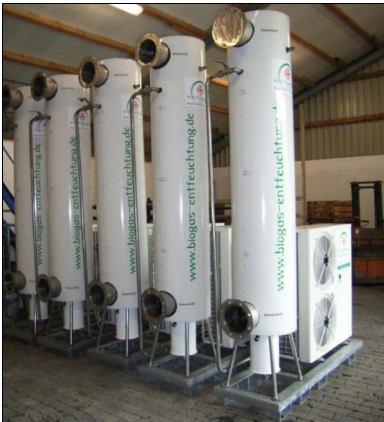
Abbildung 5-18: Gasentfeuchter für das Mischgas
