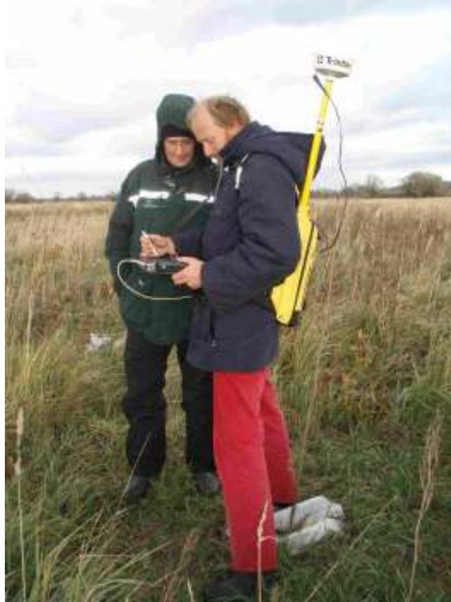
Abb. 10: Einmessung der Pflanzen mit einem Differential-GPS
