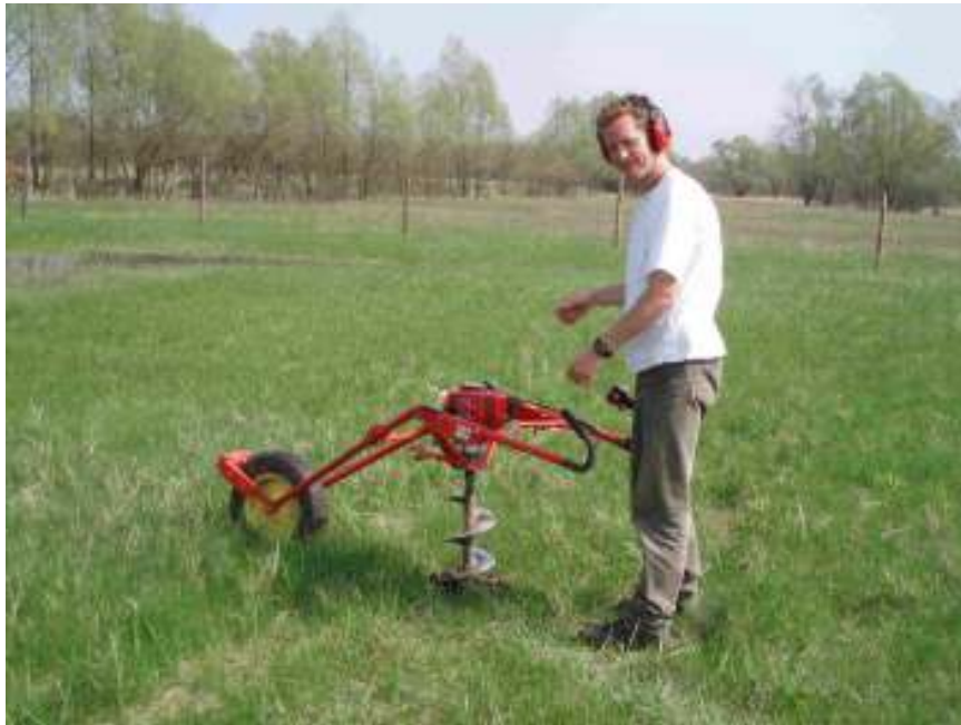
Abb. 20: Pflanzlochbohrer im Einsatz (Fläche A5)
