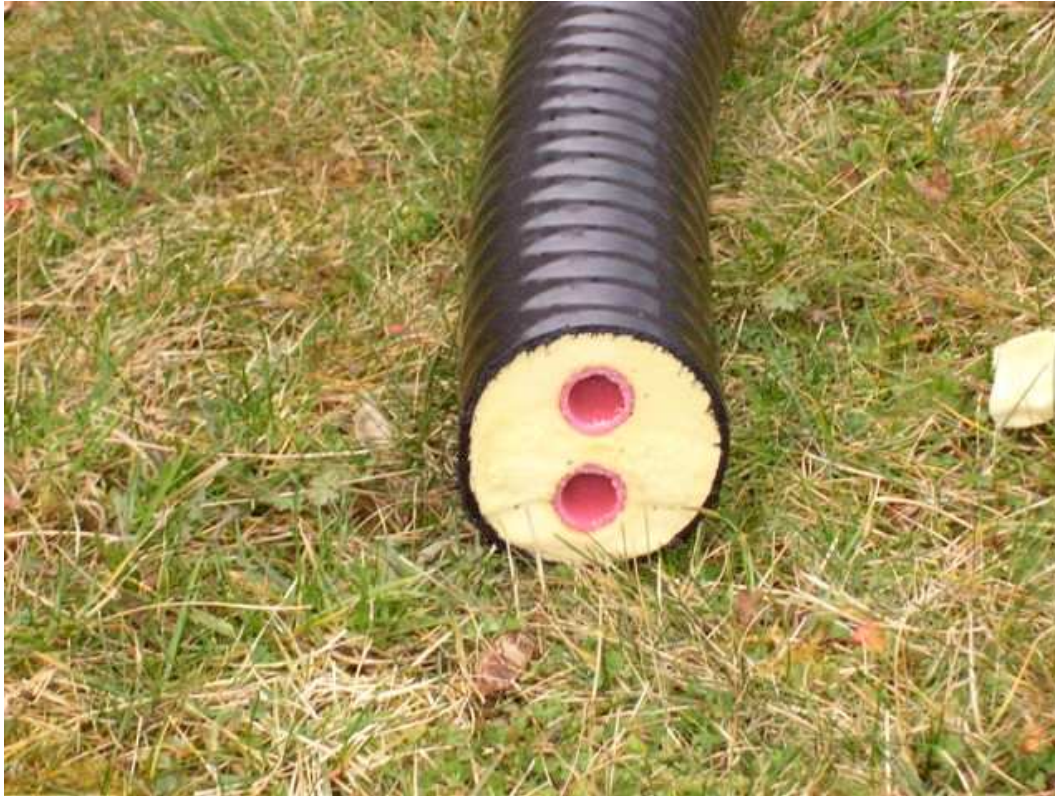
Bild 4: Warmwasserleitung einschließlich Rücklaufleitung vom Heizwasserkreislauf der Kläranlage bis zum Steuer-, Regel- und Messschrank
