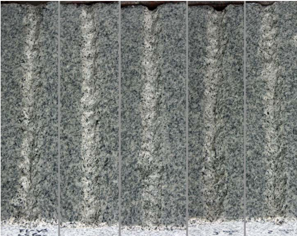
Bild 18 Vorschubuntersuchung mit U_p = 280 \text{ kV} auf Branco Micaela, v.l.n.r. v = 6 \text{ mm/s} , 5 \text{ mm/s} , 4 \text{ mm/s} , 3 \text{ mm/s} , 2 \text{ mm/s}
