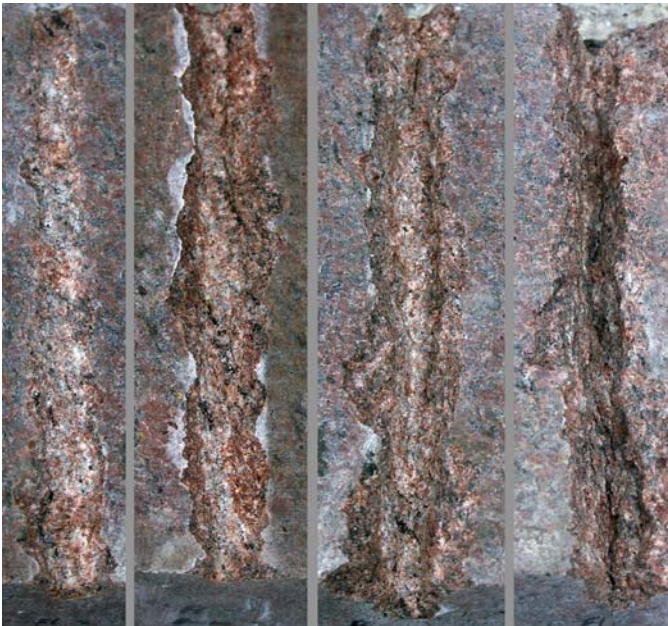
Bild 13 Bearbeitungsspuren auf Vanga Rosso, v.l.n.r. 6 mm, 8 mm, 10 mm, 12 mm
