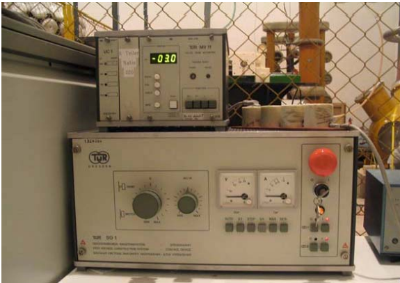
Bild 9 Messung der Ladespannung (rechts) und der Stossspannung (links)
