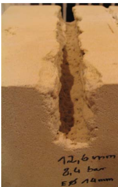
Bild 20 Schnittergebnis mit Rundstahlelektroden im Sandstein
