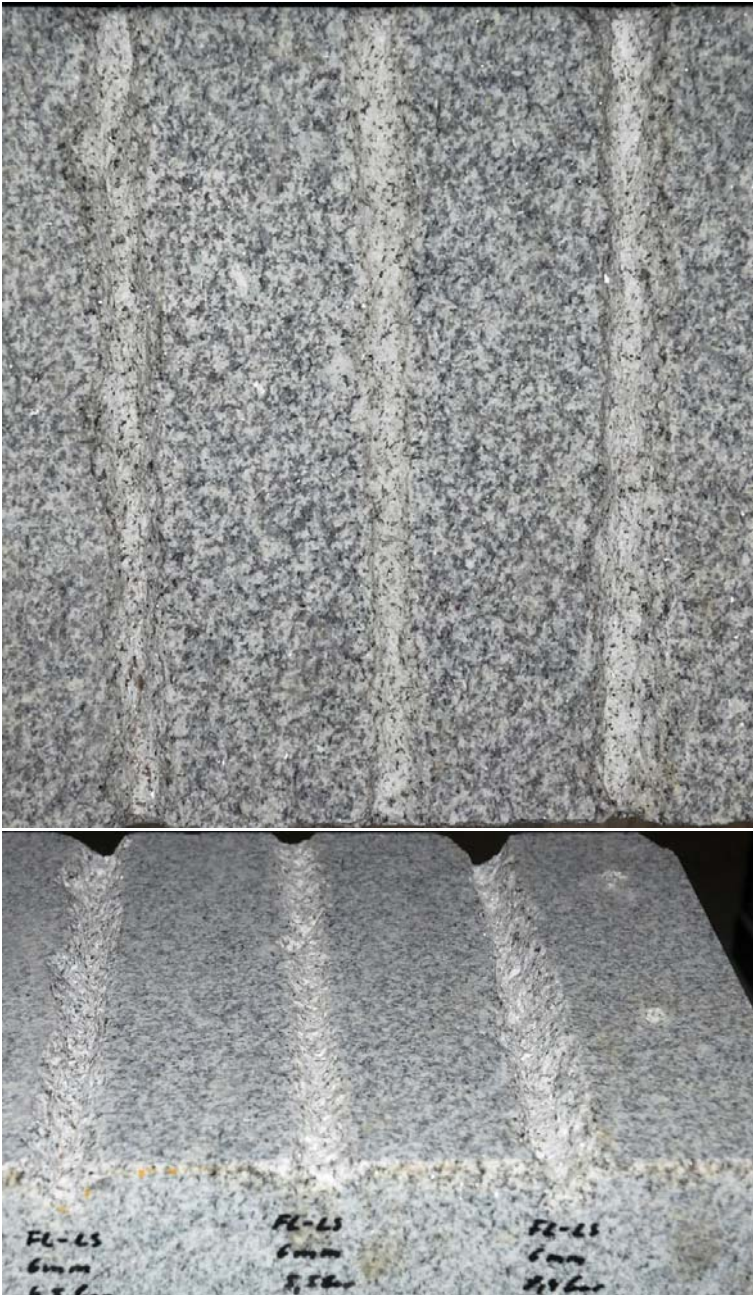
Bild 15 Bearbeitungsspuren mit verschiedenen Durchschlagsspannungen, v.l.n.r. U_P = 280 \text{ kV}, 230 \text{ kV}, 330 \text{ kV}
