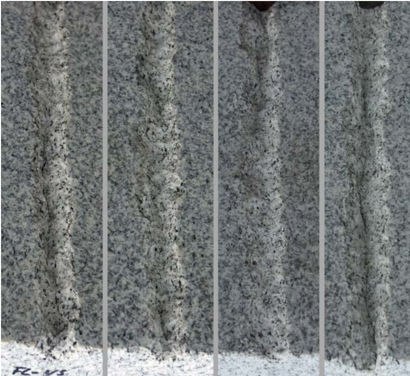
Bild 19 Vorschubuntersuchung mit U_P = 230 kV auf Branco Micaela, v.l.n.r. v = 6 mm/s, 5 mm/s, 4 mm/s, 3 mm/s
