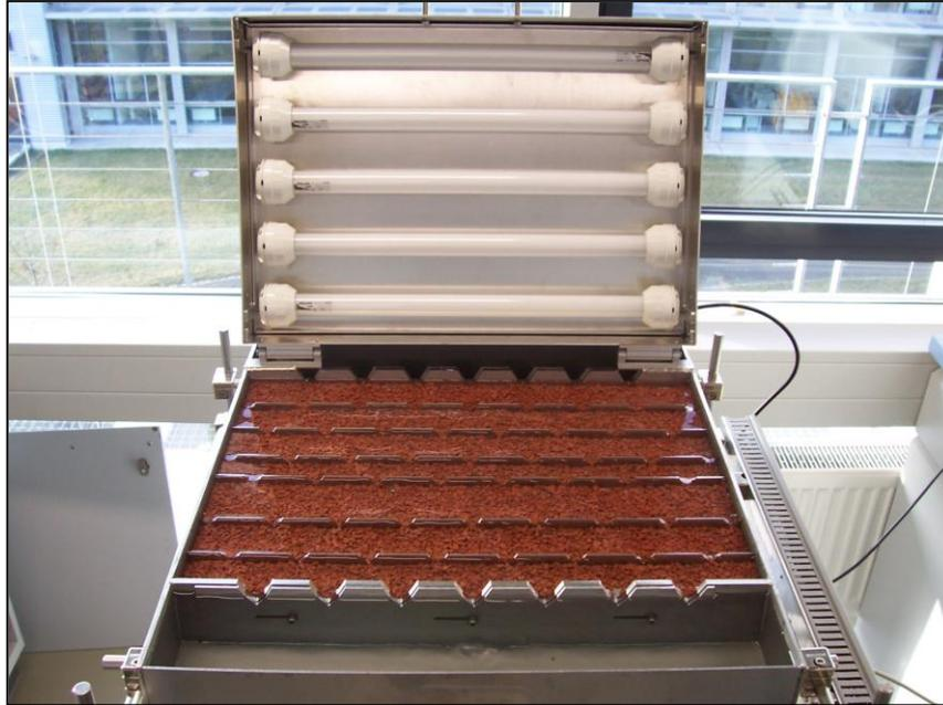
*Abb. 3.2b: Festbett mit UV-Strahlern (Anlage geöffnet)*
