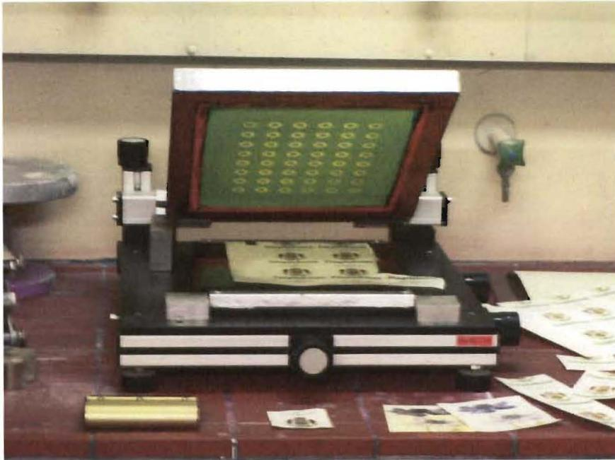
Bild 3: Versuchsaufbau zum Siebdruck
