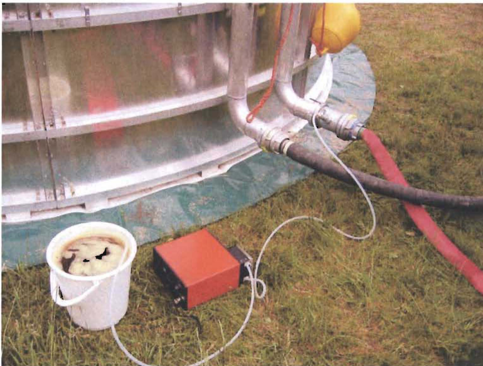
Mischereinsatz zur Flockungsmitteldosierung bei der THW – Trinkwasseraufbereitung (Feldeinsatz)
