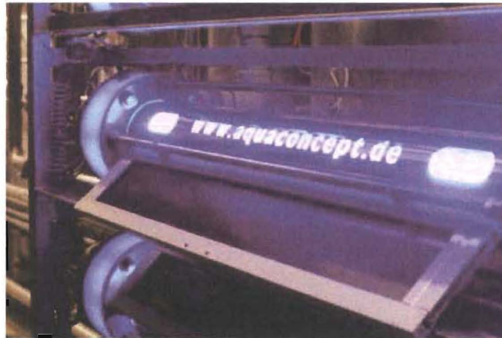
Enviolet®-UV-Reaktor der Firma a.c.k. aqua concept bei der Wirkstoffelimination aus dem Abwasser einer pharmazeutischen Mutterlauge.
