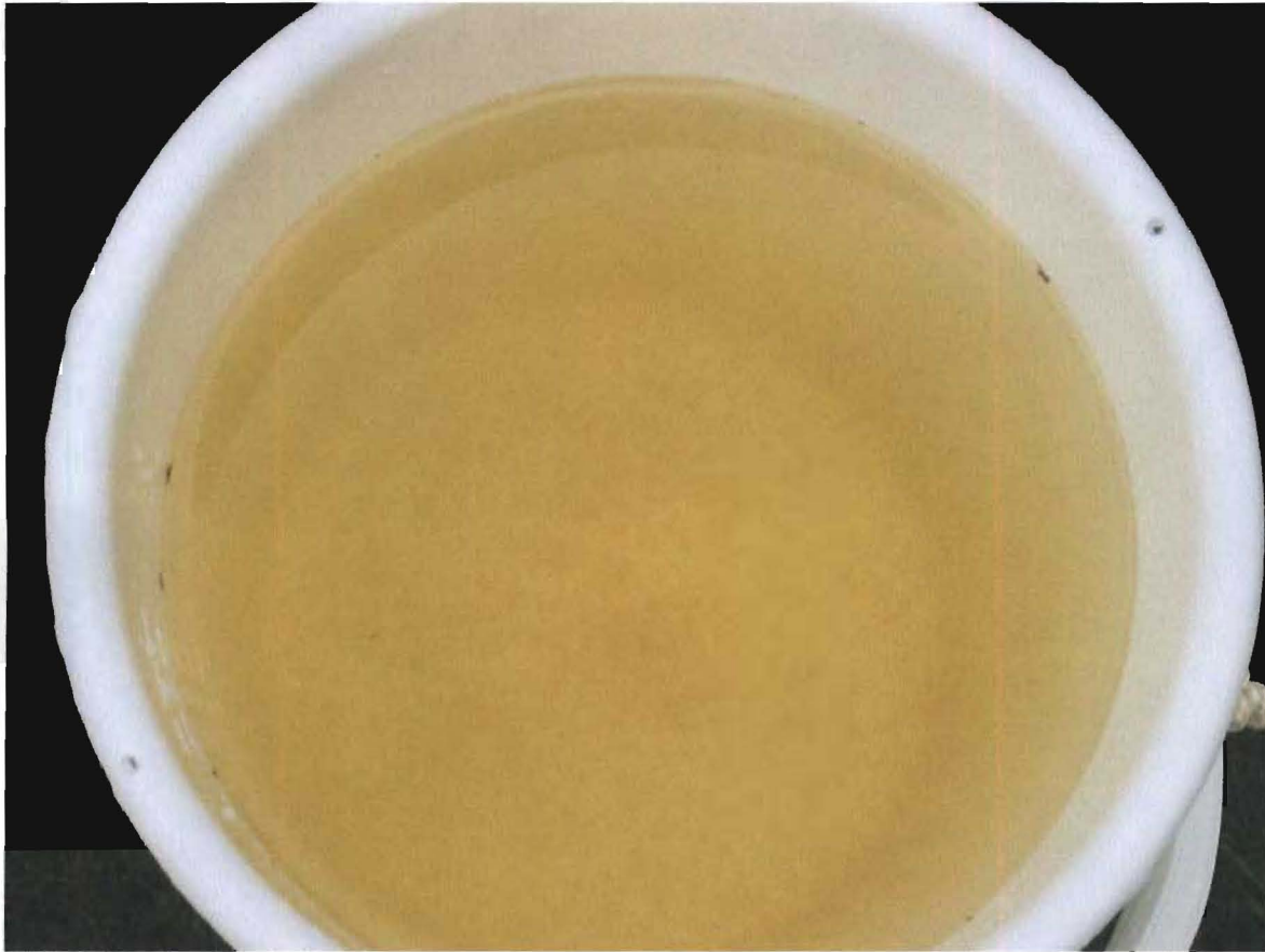
Abb. C-30: Nachweis der homogenen Fällung und Flockung im Rohwasser (Alte Fahrt)
