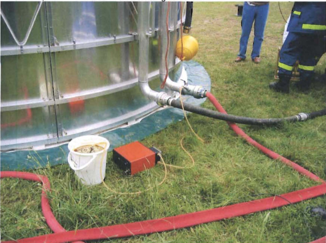
Abb. C-29a,b: Mischereinbau in die Zuleitung zum Becken
