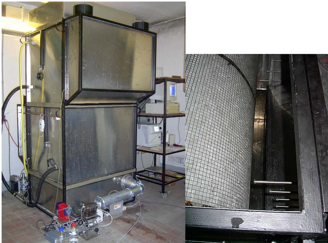
**Abb. 8.2: Prototyp BEGA Trommel, links: Gesamtansicht, rechts: Trommel mit Füllkörpern**
