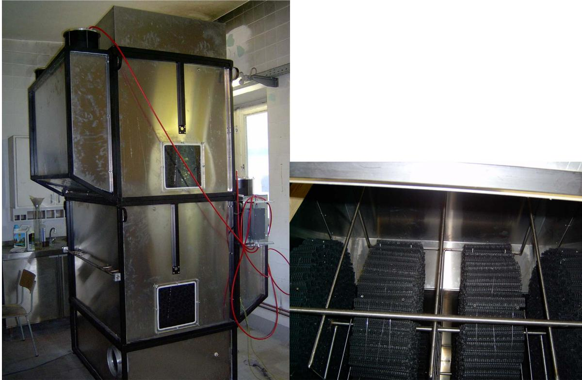
**Abb. 8.4: Prototyp BEGA Scheiben, links: Gesamtansicht, rechts: Scheiben-Packung**
