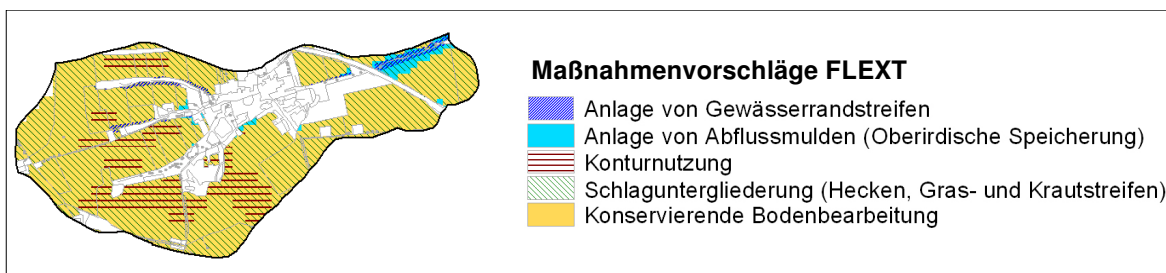
Abbildung 80: Vom Expertensystem FLEXT generierte Maßnahmenvorschläge zur Verbesserung des Wasserrückhaltevermögens auf den Ackerflächen im EZG Mockritzer Bach
