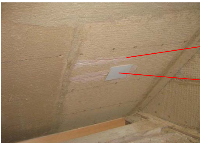
Abb. 4.33: Anordnung der Messstrecken im 3. Dachgeschoss, Wärmestrommessplatten, Temperatursensoren (Ntc)
