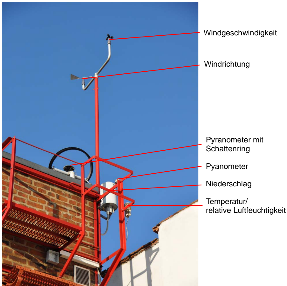
Abb. 4.3: Klimamessstation
