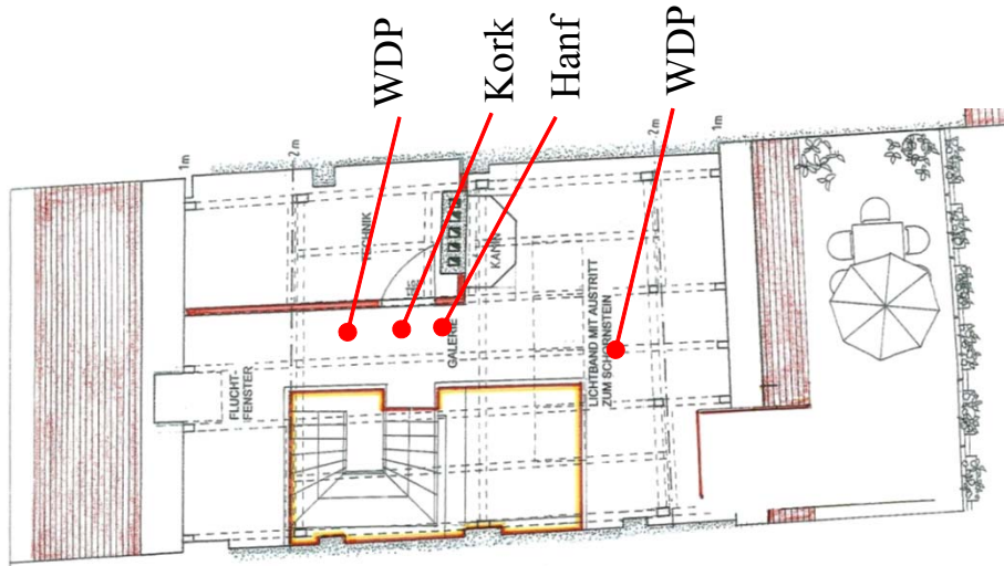
Abb. 4.30: Anordnung der Messstrecken 6. bis 9. im 3. Dachgeschoss (Spitzboden)
