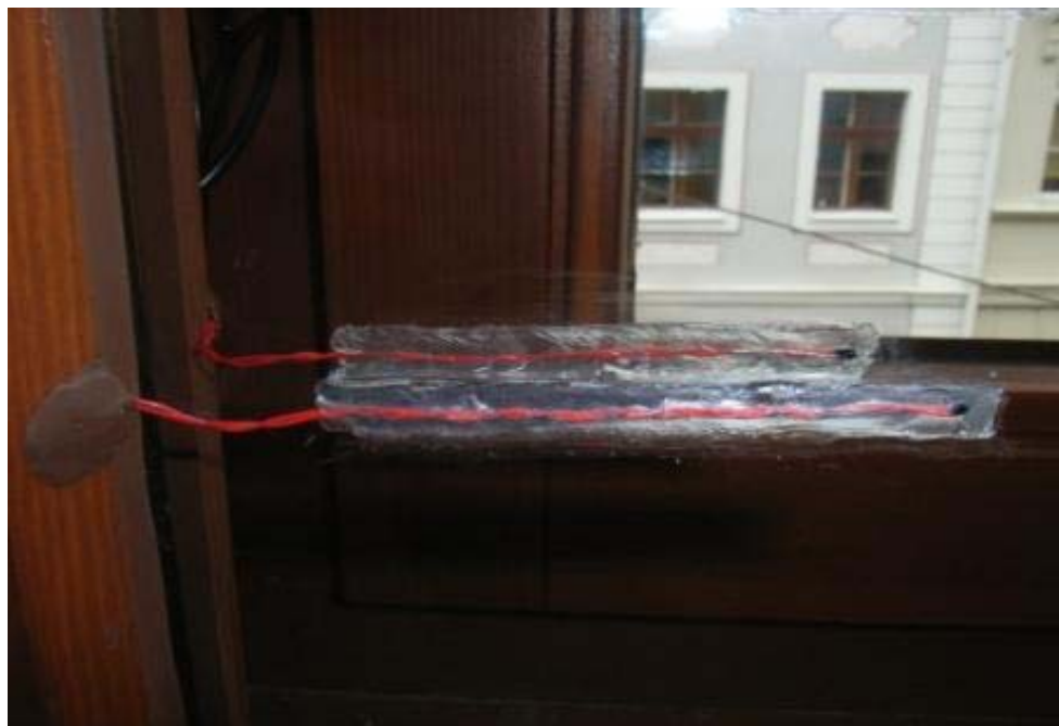
Abb. 4.37: Kastenfenster, 2. OG Nord, Aufzeichnung der Scheibenoberflächentemperaturen mit Ntc-Fühler
