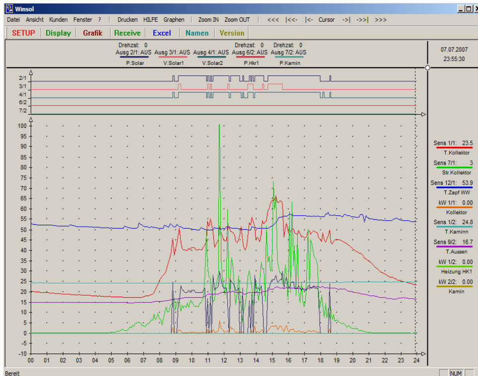
Abb. 4.45: Visualisierung der Anlagentechnik mit dem Programm WINSOL, Beispiel, Solaranlage, Heizkreis 1, Kaminheizkessel und Warmwasser am 07.07.2007
