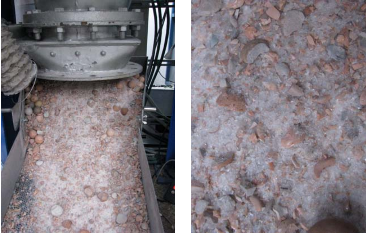
Bild 7.13: Entleerung mit hoher Staubfracht und Struktur der Siliziumdioxidanhaftungen.
