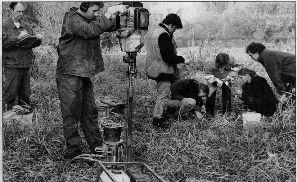
Mit umfangreichen Bodenbohrungen begannen die Vorarbeiten zur möglichen Reaktivierung der Ölganginsel.
