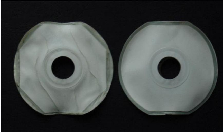
**Abbildung 4.34:** Bilder von einem unbenutzten Membrankissen (rechts) und von einem der beim Langzeitversuch eingesetzten Membrankissen (links).
