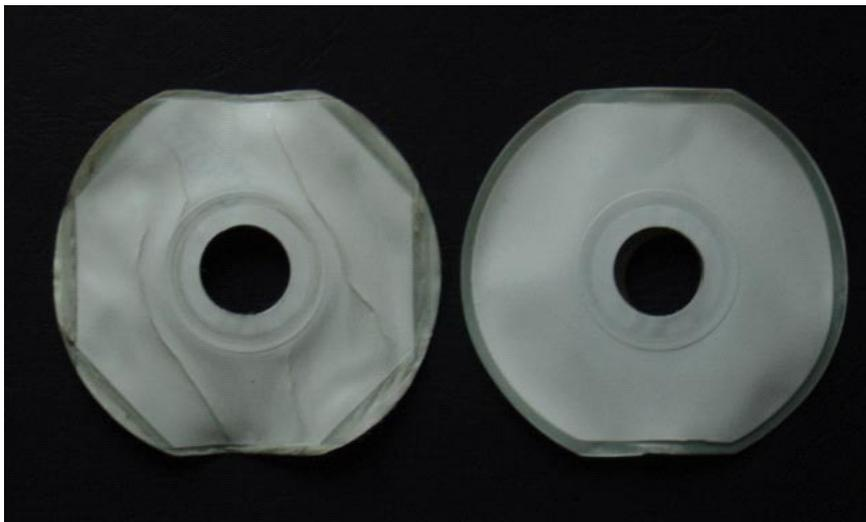
**Abbildung 3.17:** Vergleich des Schweißergebnisses mit der manuellen (links) und der maschinellen (rechts) Verschweißung.
