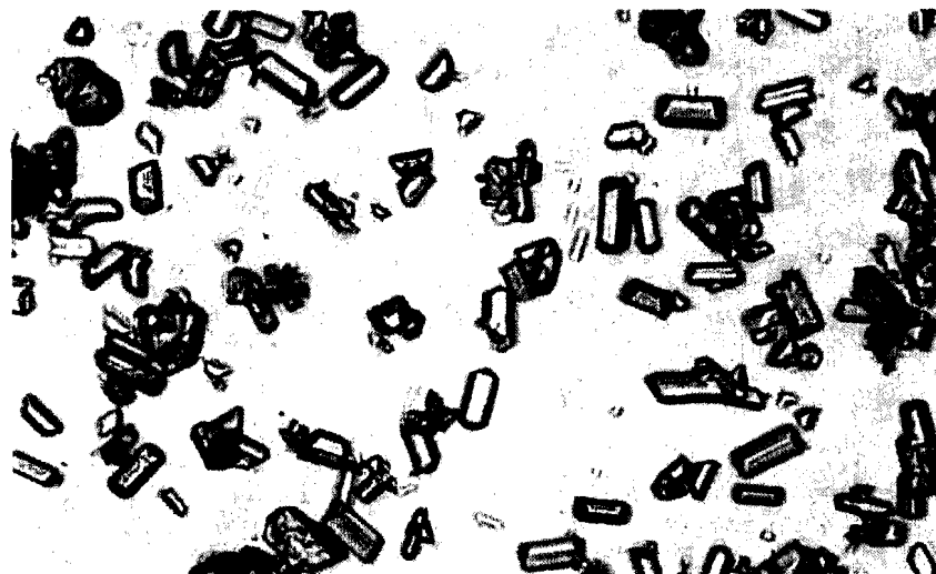
Abbildung 26: Fällprodukt des Versuchs B vom 29.04.2004; ca. 100-fache Vergrößerung
