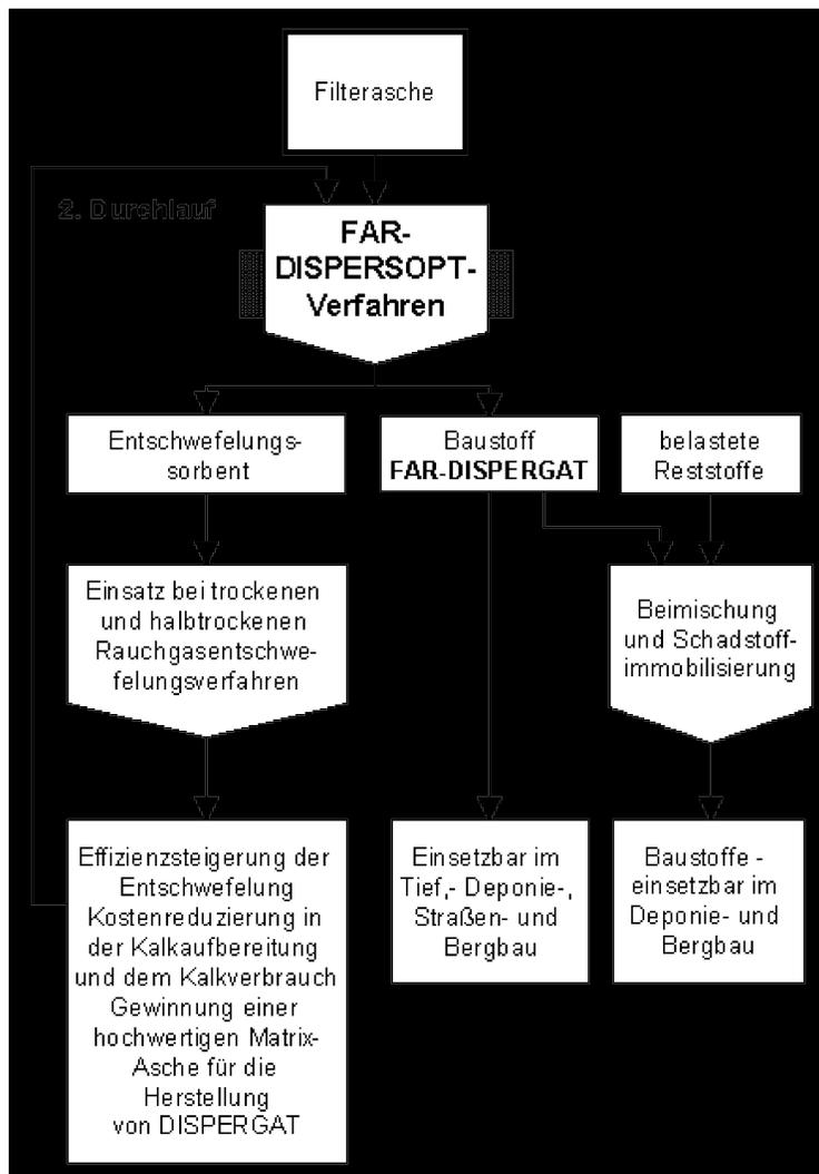
Abb. 2: Fließdiagramm zur Bindemittelherstellung
