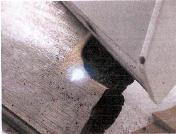
Abb. 3 Laserstrahlabtrag an Altholzteilen mit natürlicher Biozidalterung
