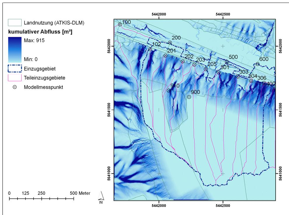
**Abbildung 8: Szenario räumliche Verteilung der Oberflächenabflussentstehung im Untersuchungsgebiet bei optimierter Direktsaat (GEOGNOSTICS 2007)**
