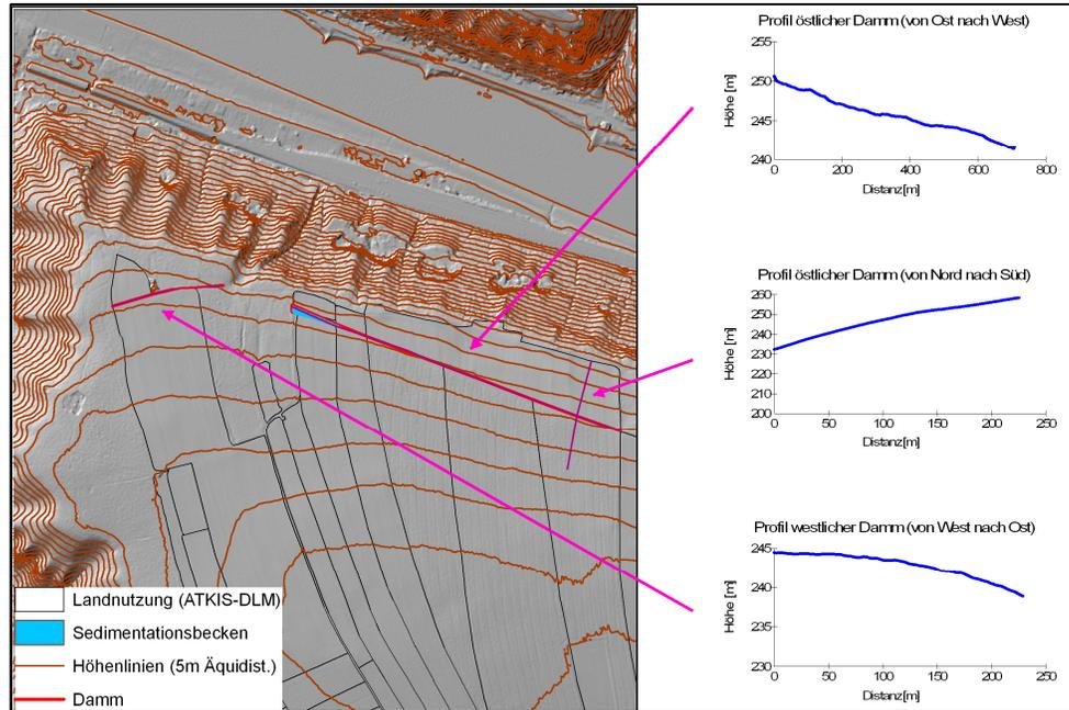
**Abbildung 7: Vorschläge zur Anlage von Leitdämmen und eines Rückhaltebeckens (GEOGNOSTICS 2005)**
