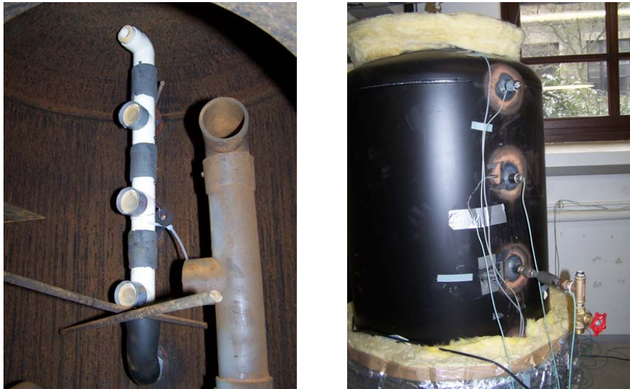
Abbildung 5.13: Integration des wärmepumpenseitigen Schichtenladerohrs in den oberen Speicherbereich
