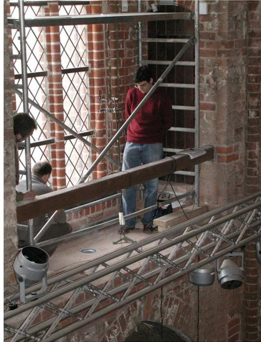
**Bild 3: Aufbau Messeinrichtung Kaltluftabfall an Kirchenfenstern**
