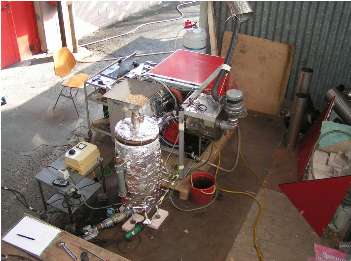
*Bild 9: Neuer absteigender Vergaser, noch mit manueller Pelletzufuhr*
