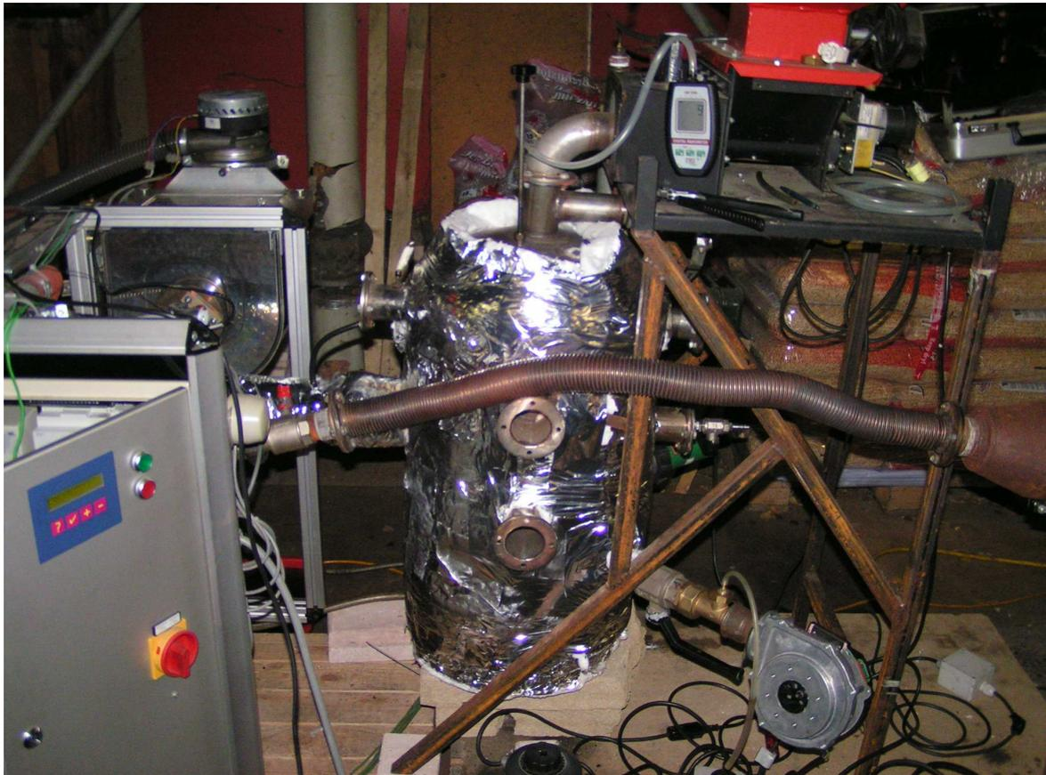
*Bild 8: In der Mitte der Vergaser, links das Stirling- Modul*
