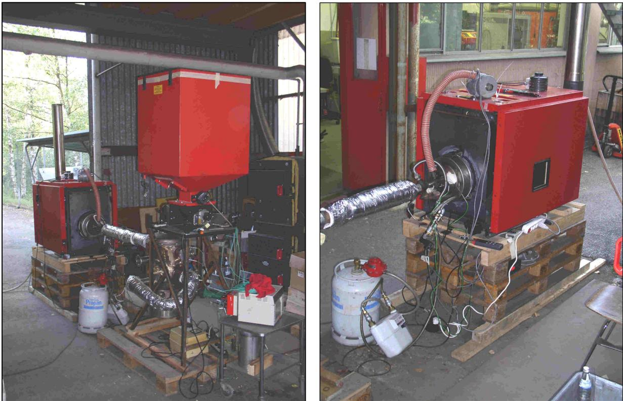
*Bild 4: Vergaser- Prüfstand bei Hoval mit Stirling- Brenner in Heizkessel*
