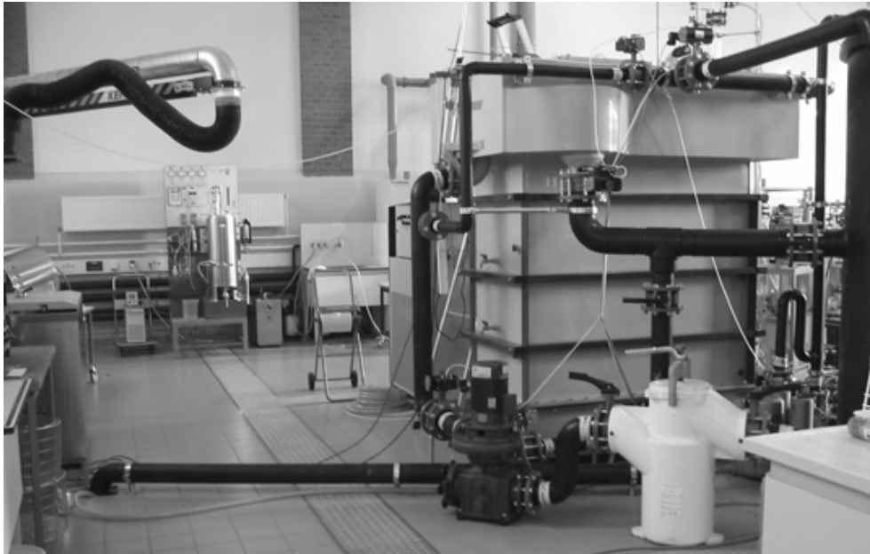
Abb. 3.16: Filter mit zusätzlicher Abflussleitung
