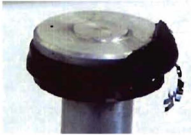
Bild 3.2: Ringschaden durch Fließen des Materials in den Spalt Kolben-Zylinder (s)
