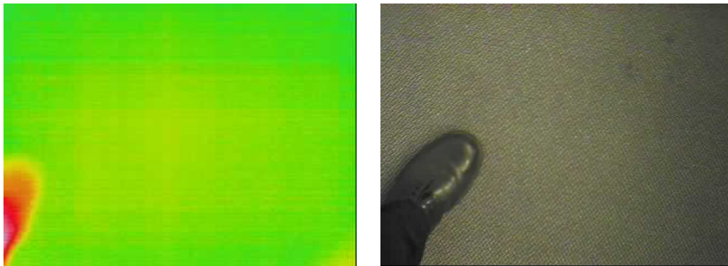
Abbildung 85 Bodenaufnahme DMH (Farbton entspricht 18°C, Fuß als Maßstab)
