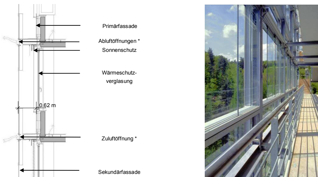
Abbildung 49 Fassadenschnitt Bürogeschoss mit der Erschließung
