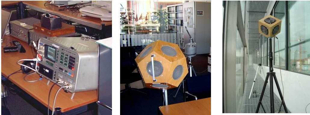
Abbildung 131 Messanlagen zur Bestimmung des mittleren Schalldruckpegels und der Nachhallzeiten in den Büroräumen und in den Fassadenzwischenräumen
