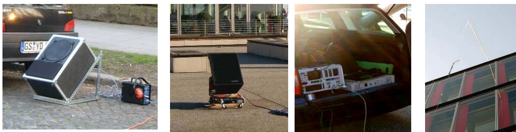
Abbildung 130 Messanlagen zur Beschallung und zur Pegelmessung 2 m vor der Fassade
