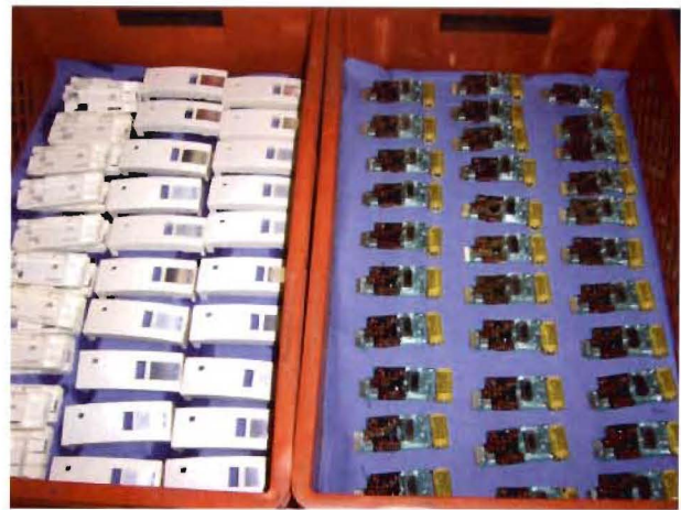
Bild 23: Montage der EHKV
