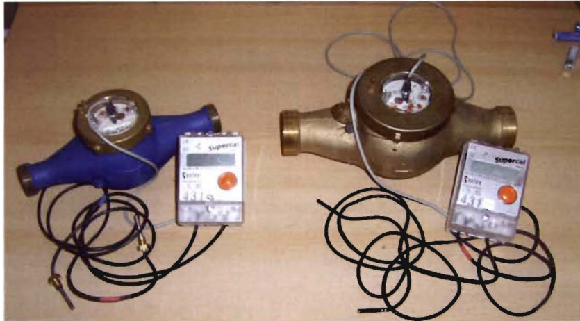
Bild 2: Supercal 431 mit Mehrstrahler MTW Qn3,5 und Qn10m³/h
