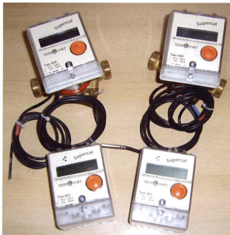
Bild 25: regenerierte Kompaktwärmezähler und Splitrechenwerke für den Einsatz auf dem russische Markt
