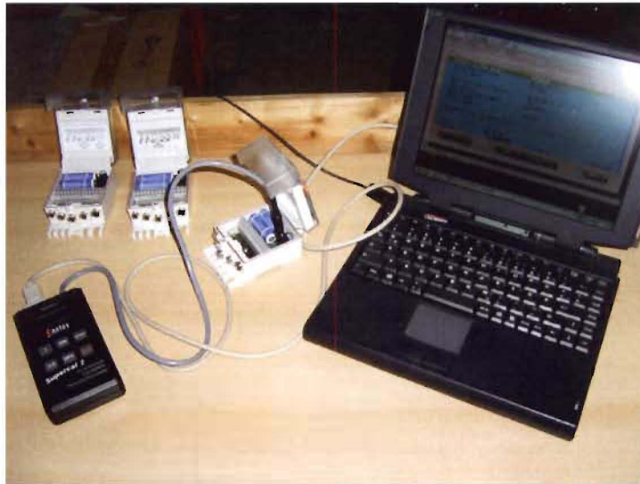
Bild 18: Arbeitsplatz für Test und Programmierung der WMZ - Rechenwerke Typ Sontex Supercal 431 und 439
