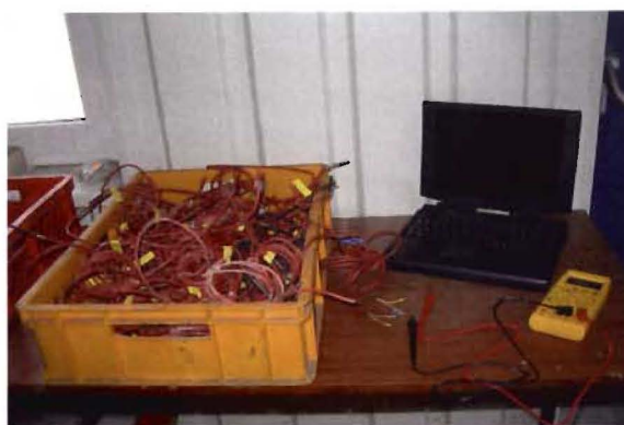
Bild 11: Test der Temperaturfühler
