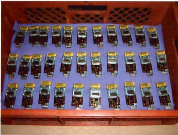
Bild 22: Batteriewechsel der EHKV
