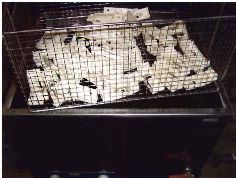
Bild 21: mit Ultraschall gereinigte HKV - Gehäuse und Rückenteile
