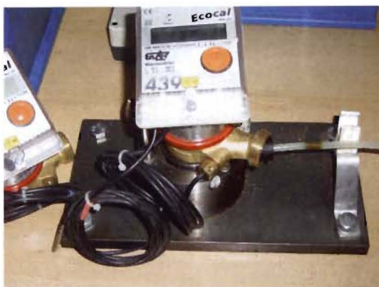
Bild 10: Test von Rechenwerk und Volumenmessteil
