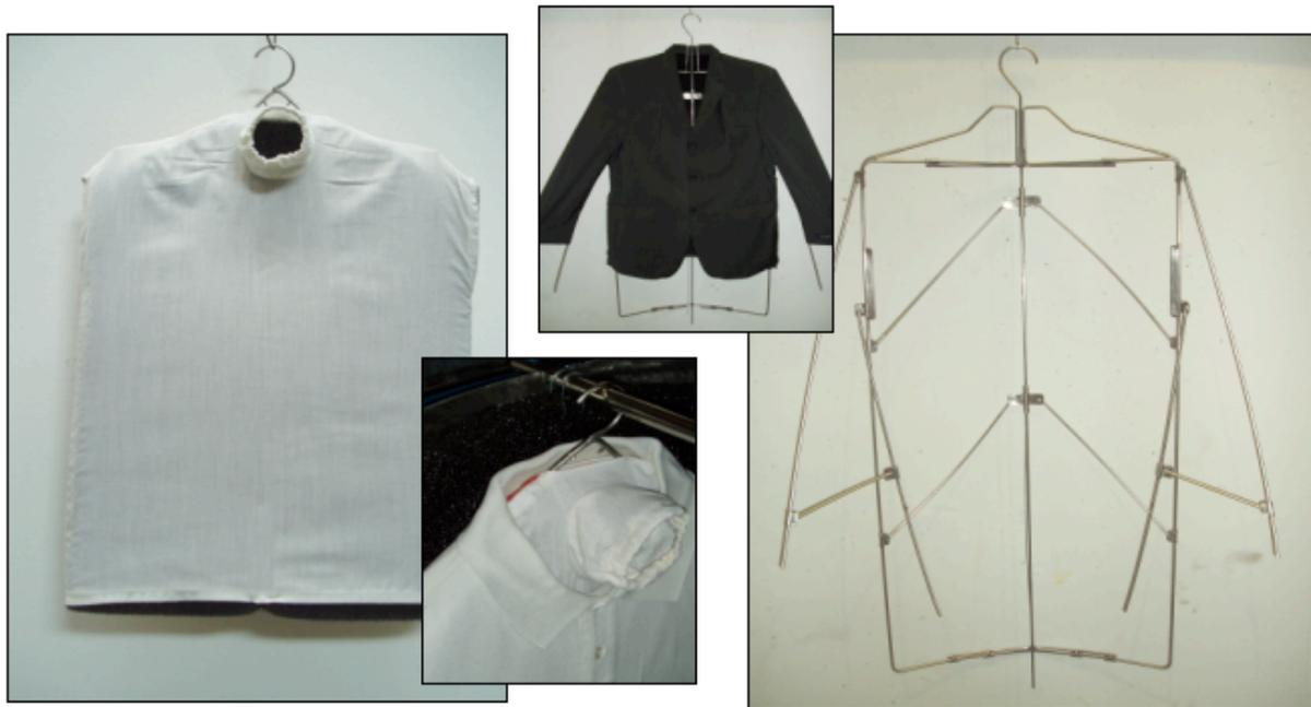
Abbildung 7: Eingesetzte Bügelsysteme zur Textilaufhängung in der Pilotmaschine.
