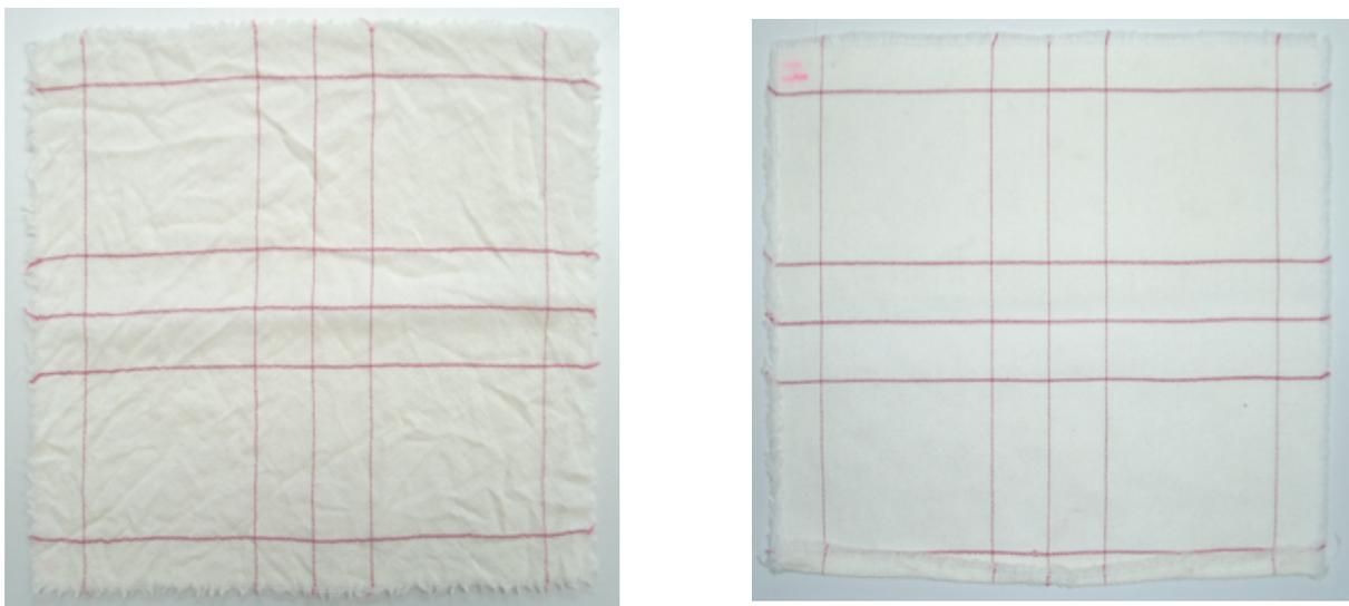
Abbildung 12: Vergleich der Testgewebe nach Behandlung in der Haushaltswaschmaschine (links) und in der neuen Nassreinigungsmaschine (rechts).
