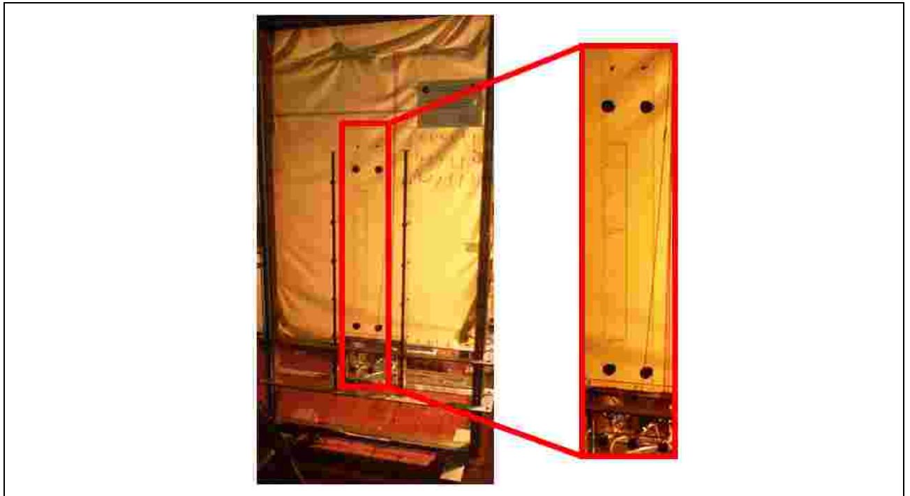
Bild 5-10: Position der Platte zur Bestimmung der Aufstiegs geschwindigkeit von Einzelblasen
