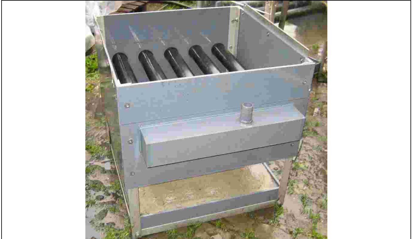
Bild 7-22: Luftzufuhrkanal für die Belüfter im Aufströmkanal
