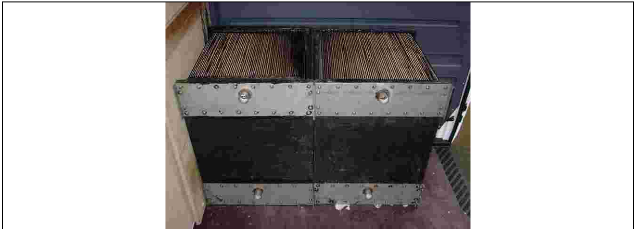
Bild R 2: Zwei Prototypen des Membranmoduls A40
