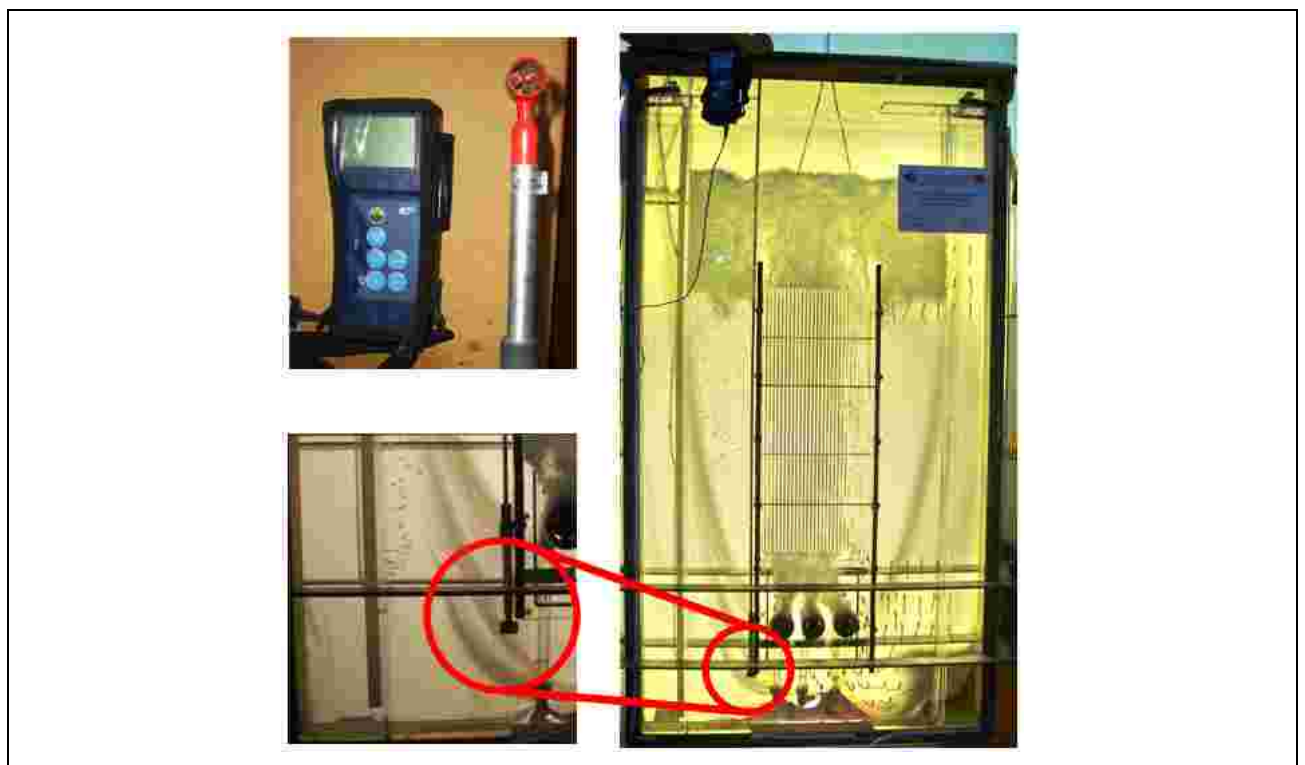
Bild 5-9: Versuchsaufbau zur Messung der Zirkulationsgeschwindigkeit
