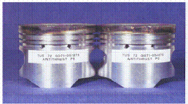
Bild 7: Ergebnis des Peugeot TU5JP gemäß CEC L-88-02 (Dritter Lauf mit geänderter Formulierung)
