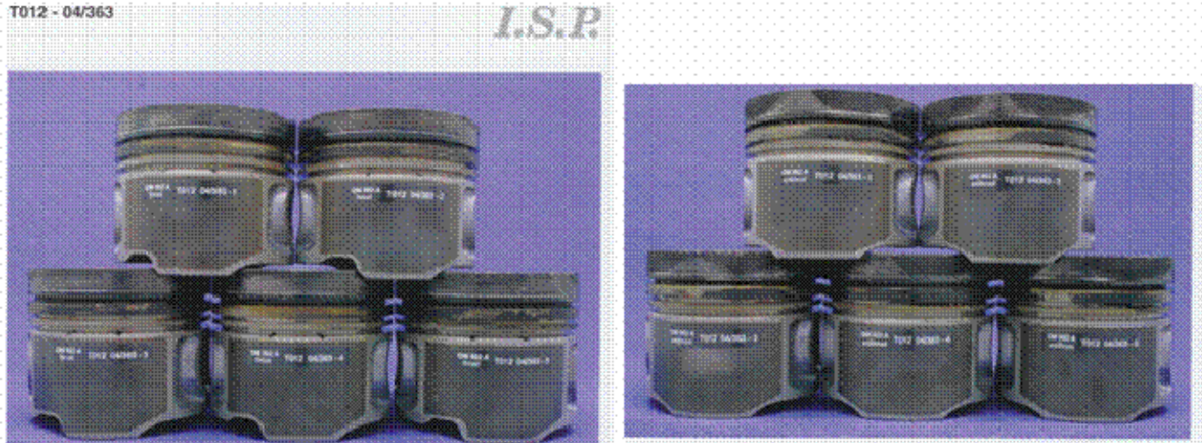
Bild 6: Ergebnis des OM 602A gemäß CEC L-51-T-98 : Bestimmung des Nockenwellenschleißes, Kolbensauberkeit, Bore Polishing.
