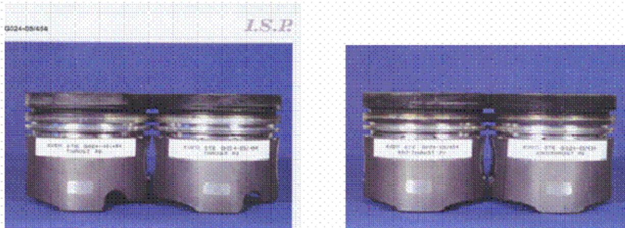
Bild 9: Ergebnis nach der Durchführung von PSA XUD 11BTE/L gemäß CEC L-56-T-98: Bestimmung des Viskositätsanstieges und der Kolbensauberkeit unter Einfluss von 3% Russeintrag (Erster Lauf)
