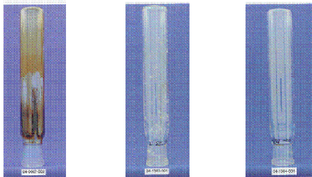
Bild 3: Ergebnisse des DKA Oxidationstest 160°C / 192h nach CEC L-48-A-00-B
