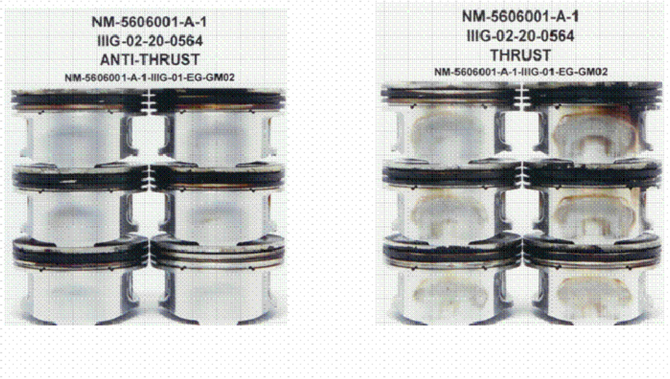
Bild 8: Ergebnis nach der Durchführung von Sequence IIIG: Bestimmung der oxidativen Stabilität, der Kolbensauberkeit, des Verschleißes und des Viskositätsanstieges (Dritter Lauf)
