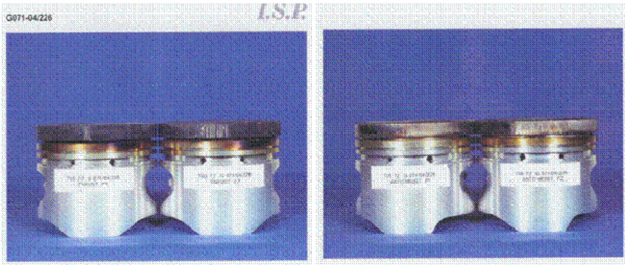
Bild 4: Ergebnis des Peugeot TU5JP gemäß CEC L-88-02
