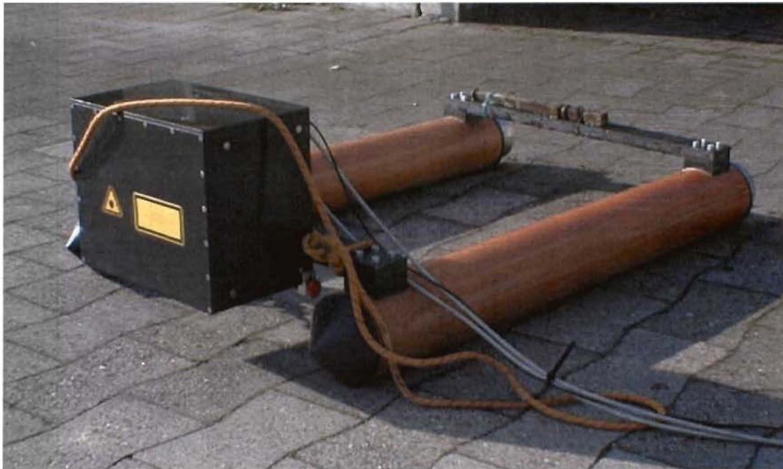
Abb. 9: Schwimmer mit Laser-Mess-Apparatur
