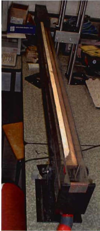
Abb. 17: Laborgerinne mit verkleinertem Querschnitt
