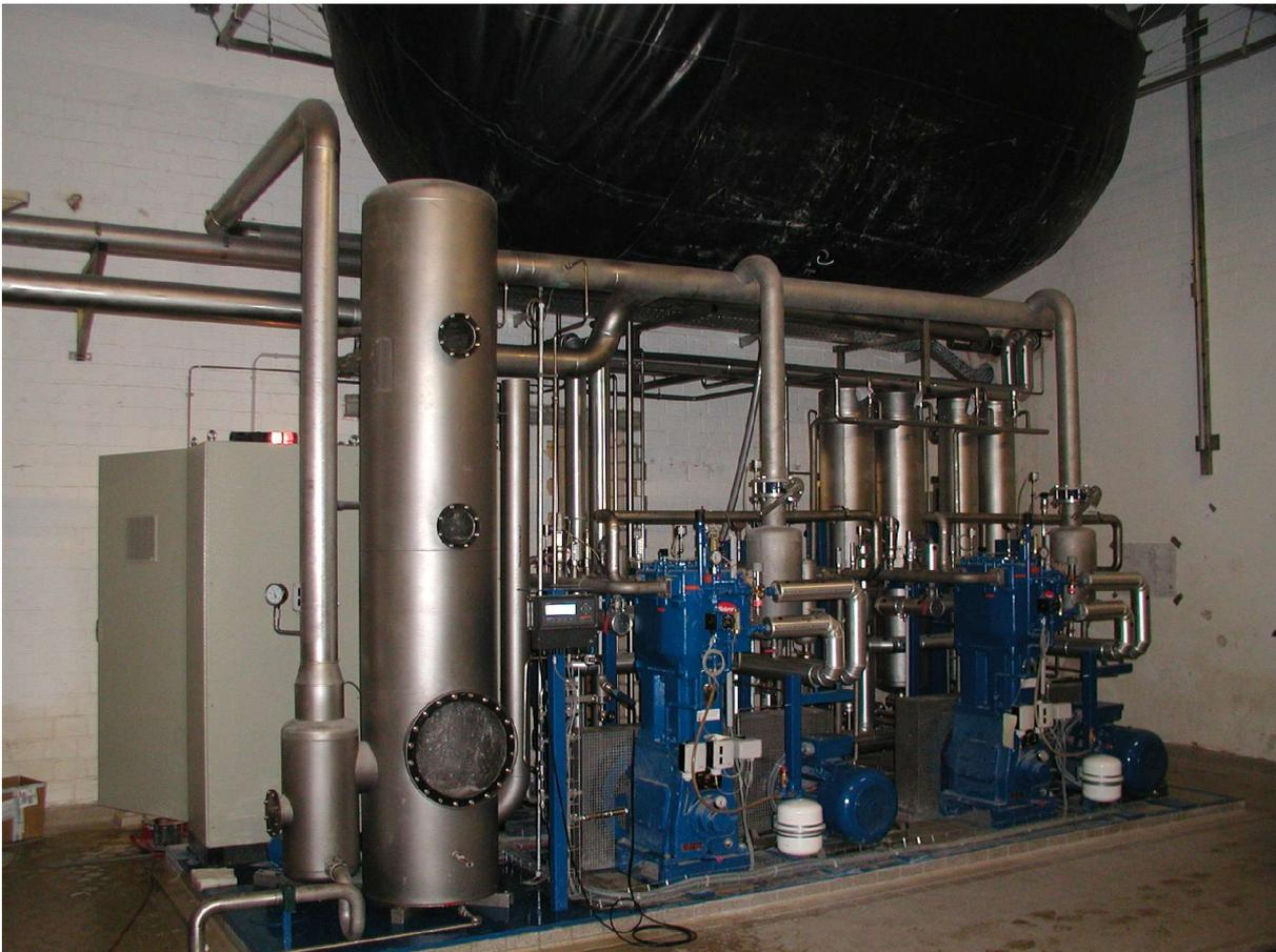
Abb. 5.1 Versuchsanlage zur CO<sub>2</sub>-Rückgewinnung
