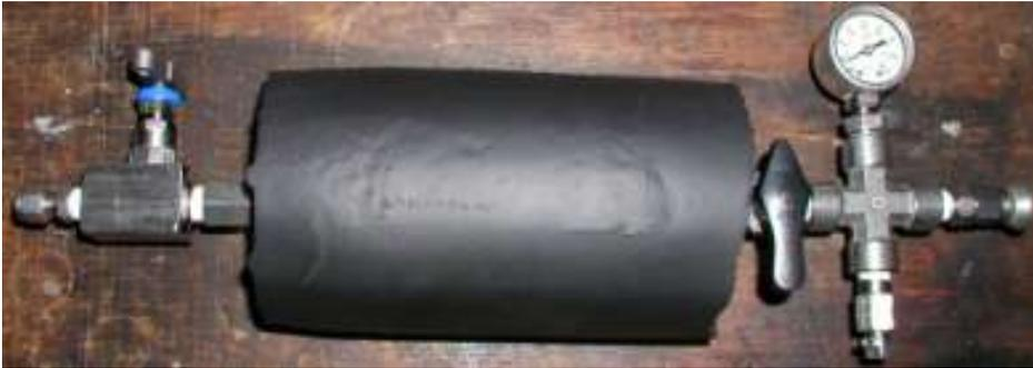
Abb. 4.3 Spezialbehälter für den Proben transport von flüssigem CO<sub>2</sub>
