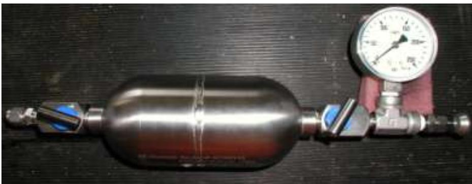
Abb. 4.2 Druckgasbehälter
