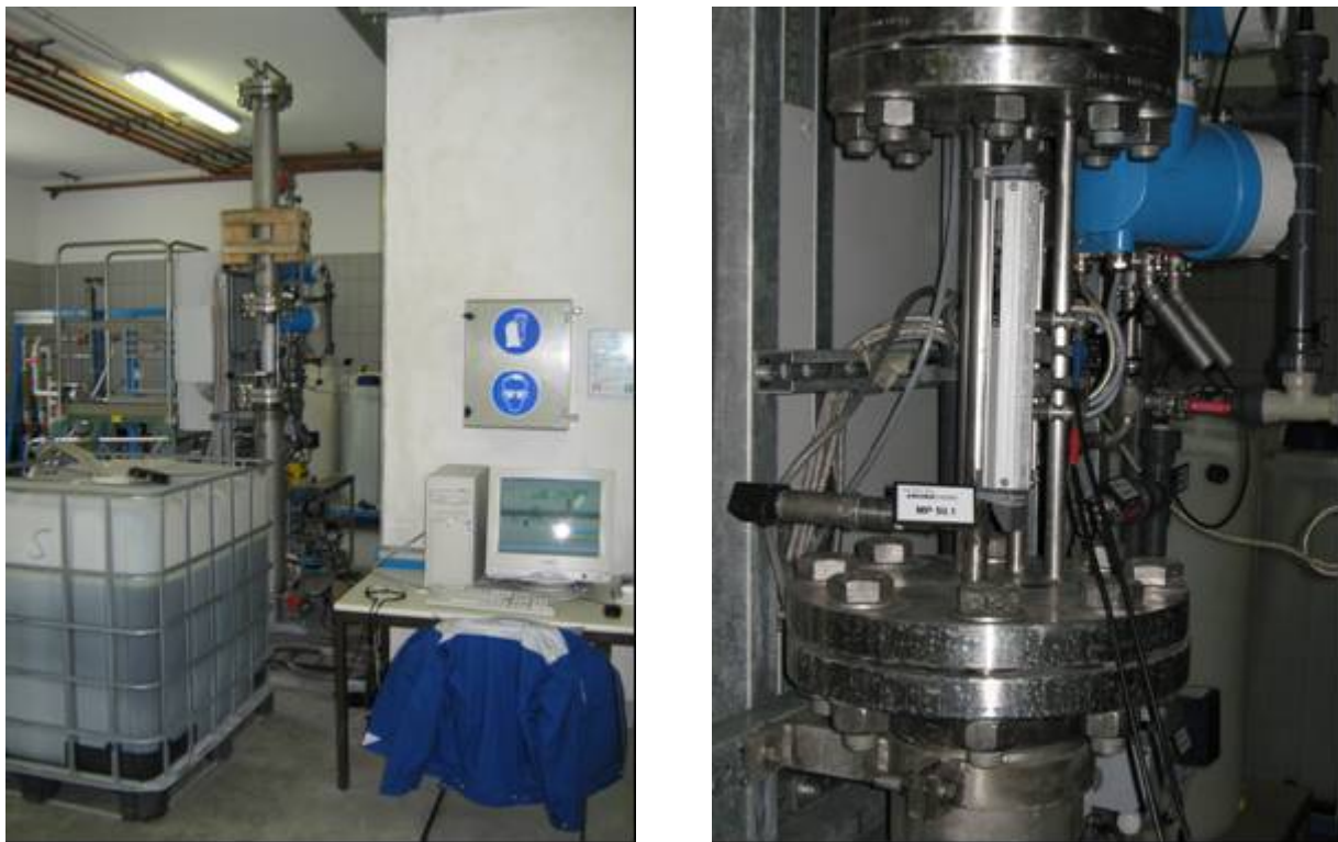
Abbildung 16 VRM Pilotanlage im Technikumsversuch (links: Versuch mit Abwasservorlage, rechts: Ultraschall-Messkopf zur Überwachung der Kreislaufströmung im Vertikal-Modul)
