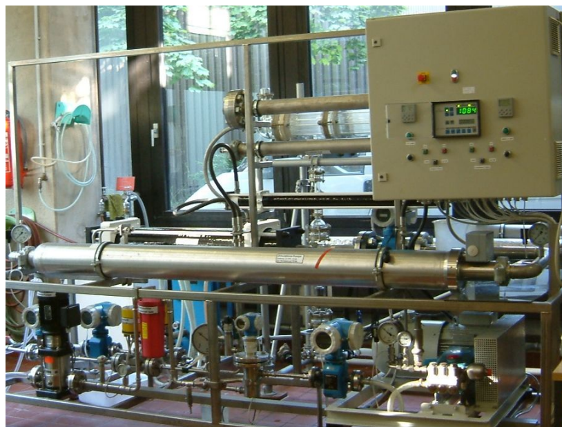
Abbildung 9 Technikumsanlage zur Bestimmung der Trenncharakteristik
