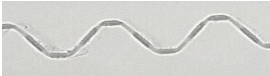
Abbildung 5 Kontur des produzierten Tunnel-Spacers
