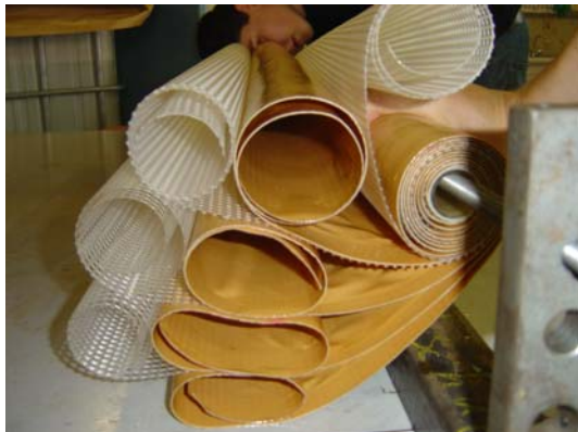
Abbildung 8 Umbau eines 4"-Wickelementes
