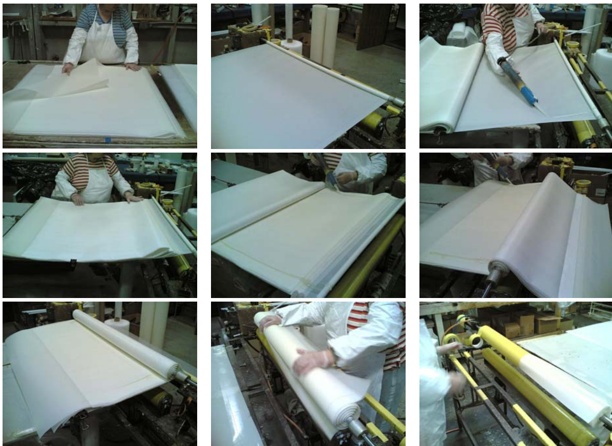
Abbildung 11 Fertigung eines Spiralwickелеlementes
