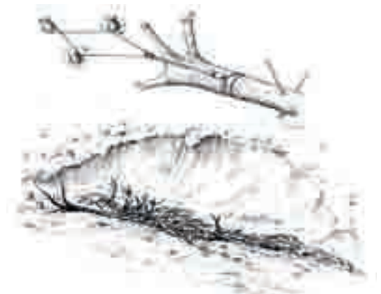
Abb. 4.3.3.-7: Skizze des Einbaus eines Raubaumes (aus PATT et al. 1998)
