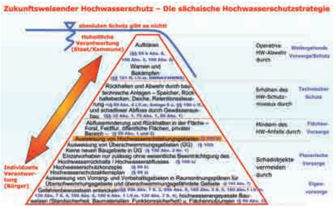
Abb. 3.4.-4: Systematik der sächsischen Hochwasserschutzstrategie nach den Regelungen des sächsischen Wassergesetzes (SächsWG), aus SMUL (2007b)
