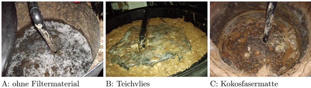
Abbildung 8.5: Separatoren A-C nach der Beschickung am 12.09.2008
