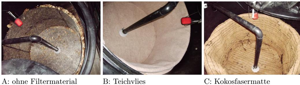
Abbildung 8.3: Separatoren A-C mit Filtermaterial
