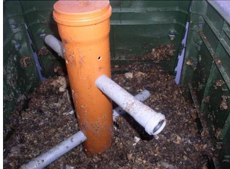
Abbildung 5.2: Innenbehälter mit Zentral- und Horizontalrohren zur Verteilung der solar erwärmten Luft [Foto M.Schön 2008]
