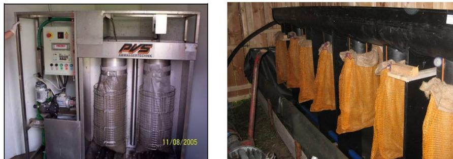
Abbildung A.7: Filtersackanlagen
