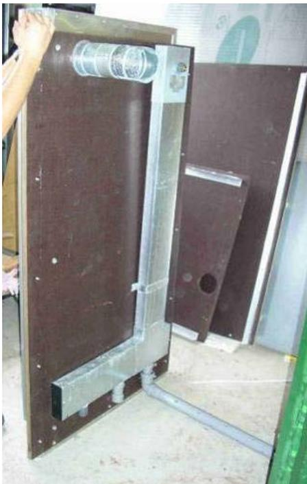
Abbildung 115: Luftauslässe und gelochtes Rohr am Warmluftkollektor
