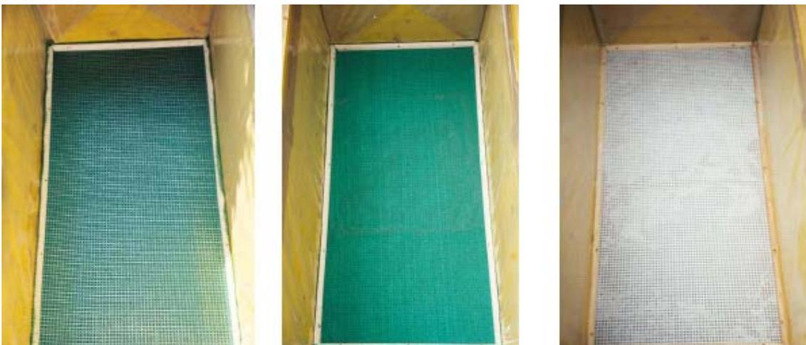
**Abbildung 4: Vorversuche an der Kläranlage Zirl / Filterbodenbelegung mit unterschiedlichen Materialien [Fotos W.Becker & M.Demattio (2003)]**
