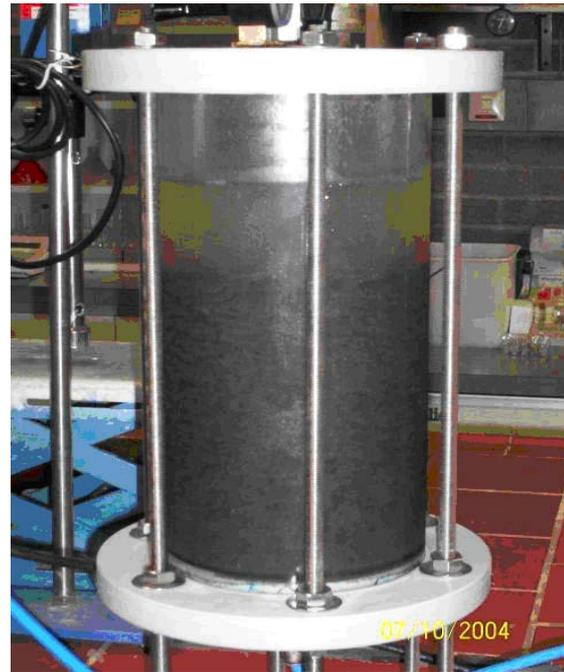
Abbildung 16: Druckzelle mit abgesetztem Schlamm und Überstandswasser
