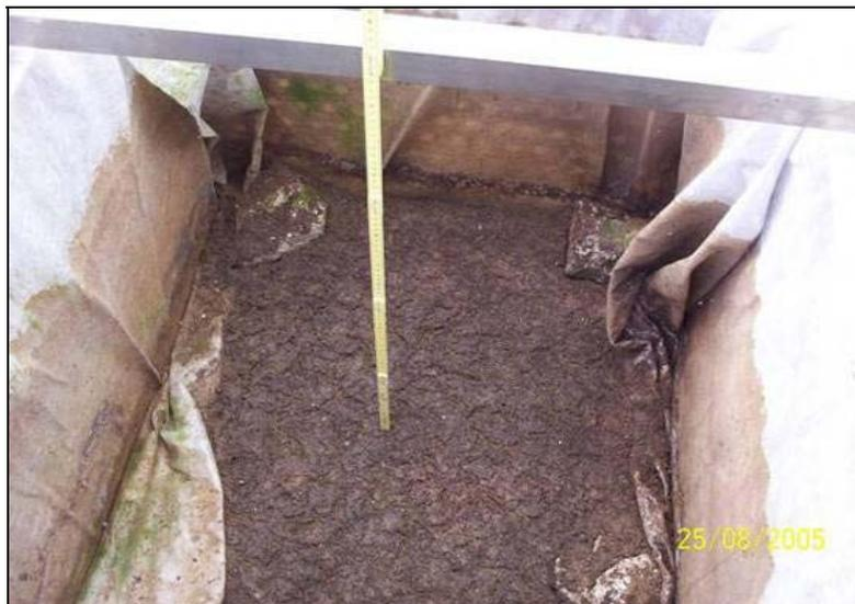
**Abbildung 58: Aufmass der abgetrockneten Überschussschlammsschicht im SEM OST [Foto M.Vallazza (2005)]**
