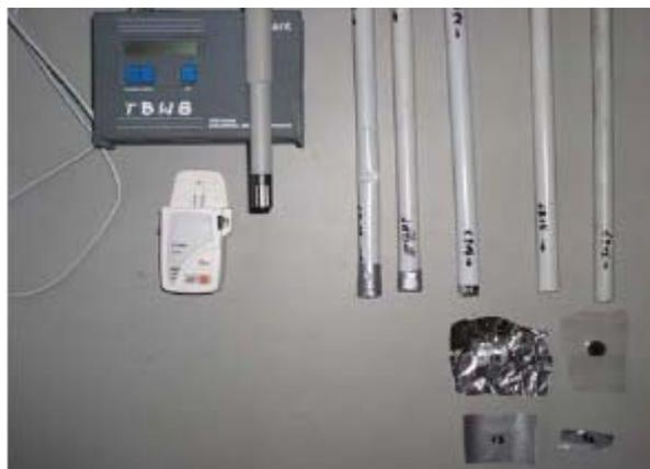
**Abbildung 94: Datenlogger für Temperatur und relative Luftfeuchtigkeit, i-Buttons (Temperaturlogger) [Foto W.Becker (2004)]**
