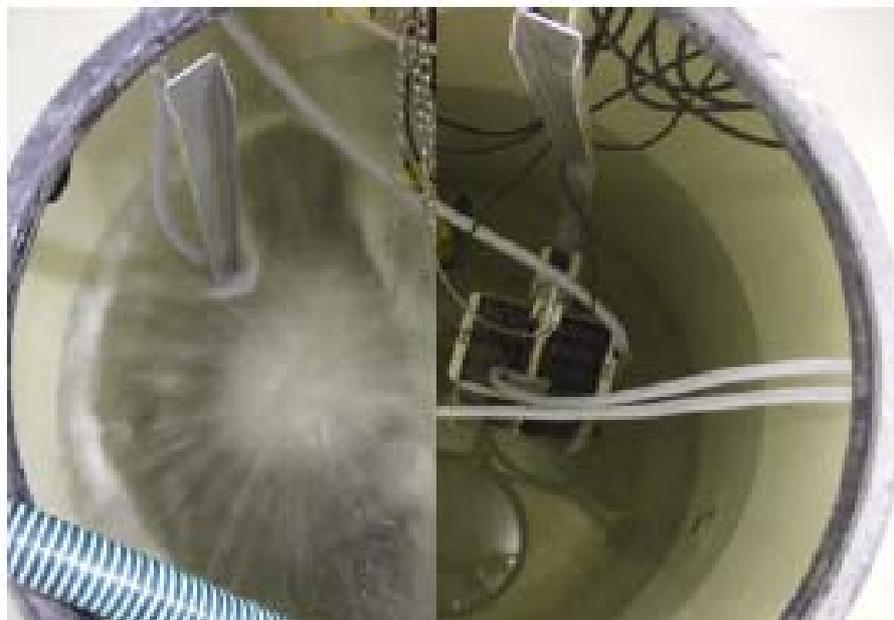
**Abbildung 140: Membranbioreaktor (wasserbefüllt) mit zwei Membranmodulen (links belüftet und rechts unbelüftet) zur Filtration des gereinigten Abwassers [BÜTZER et al. (2006)]**
