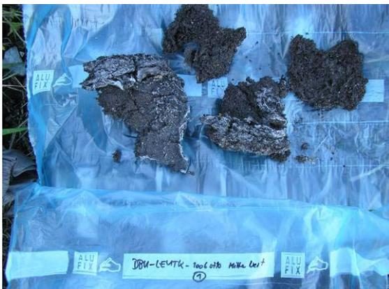
**Abbildung 50: entwässerte, ausgefrorene und solargetrocknete Schlammprobe [Foto W.Becker (2006)]**
