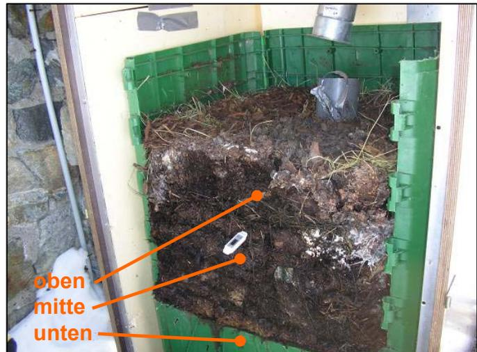
Abbildung 129: Geöffneter Innenbehälter mit Verpilzungsschicht und Temperaturmesspunkten [Foto W.Becker (2007)]
