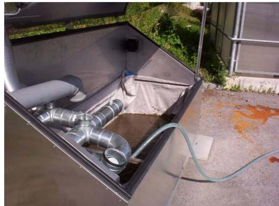
**Abbildung 24: Kompaktrockner bei Vorversuche auf der Kläranlage Zirl (Innenansicht bei der Befüllung) [Foto R.Ettl (2004)]**
