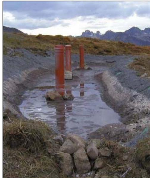
Mit der Anlage konnte der Wassergehalt von 98% auf 75% bzw. 70% gesenkt werden, was einer Volumenreduktion von über 90% entspricht. Die Mineralisierung organischer Substanzen hat im ersten Versuchszyklus kaum stattgefunden. Im zweiten Zyklus dagegen wurde eine Senkung des Glühverlustes von 86% auf 62% erreicht. Entscheidenden Anteil daran hat die Durchwurzelung der Schlammsschicht. Die Einsaat sollte möglichst früh in der Saison erfolgen.
