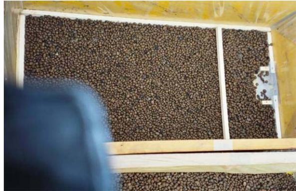
**Abbildung 3: Versuchsanlage Demattio in Zirl (Innenansicht/Dränageschicht) [Foto W.Becker & M.Demattio (2003)]**
