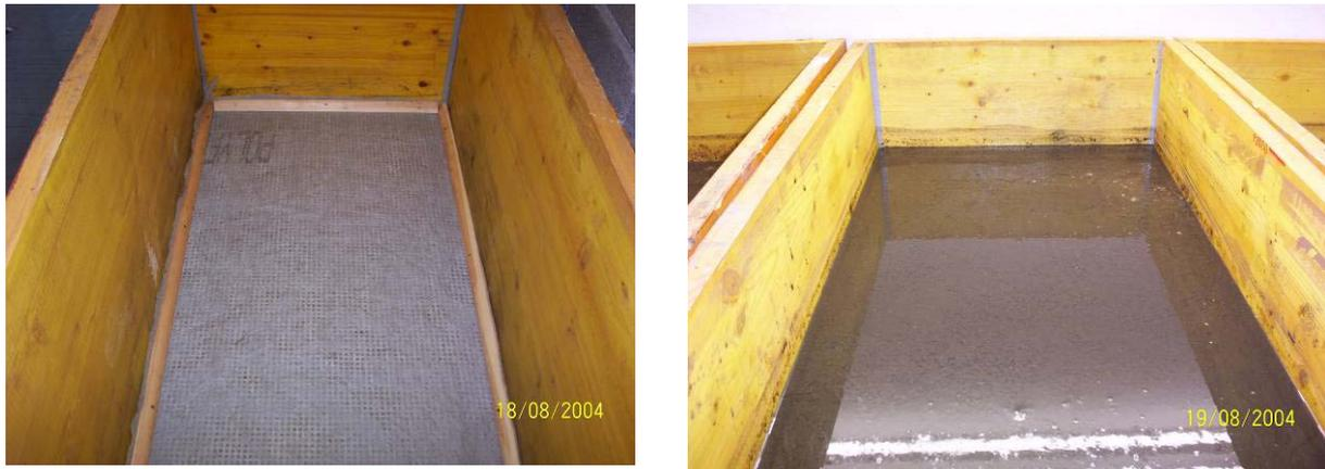
**Abbildung 19: Filterboxboden belegt mit Geotextil vor und nach der Befüllung mit eingedicktem Überschussschlamm mit Polymer [Foto M.Vallazza (2004)]**
