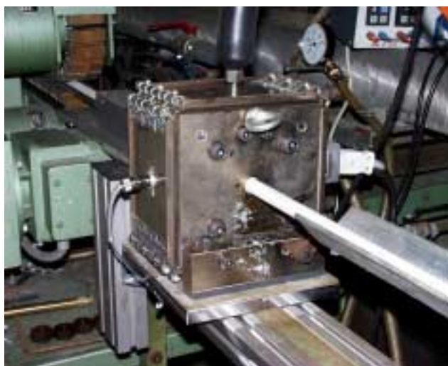
Abb. 5: Extrusionswerkzeug zur Herstellung von „Kunststoff-ummantelten“ GFK-Stäben
