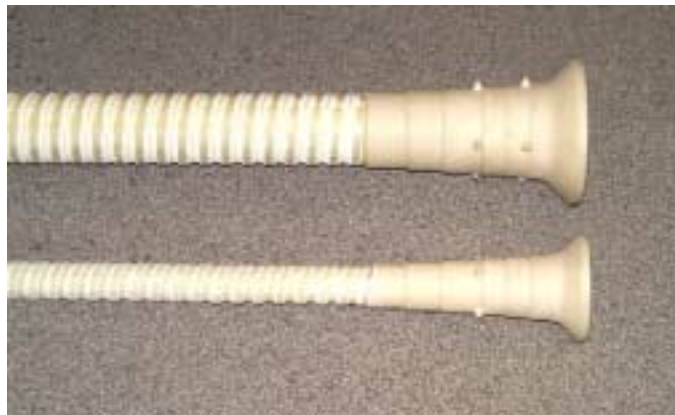
Abb. 24: entwickelte Endverankerungen in 2 Ausführungen (durchmesserabhängig)
