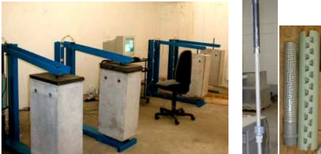
Abb. 9: Zugversuch-Prüfstand mit Detailaufnahmen (Einspannvorrichtung und beheizbarer Mantel)
