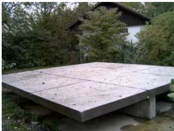
Abb. 27: Versuchsaufbau mit unterschiedlichen Isokörben unter Eigenlast
