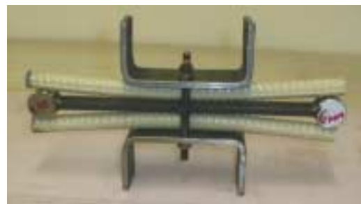
Abb. 12: Prüfbecken mit Detailaufnahme Einspannvorrichtung
