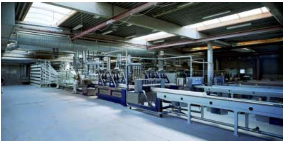
Abb. 7: Pultrusionsanlage bei Fiberline, an der die Versuche im Projekt durchgeführt und umfangreiche Optimierungen umgesetzt wurden
