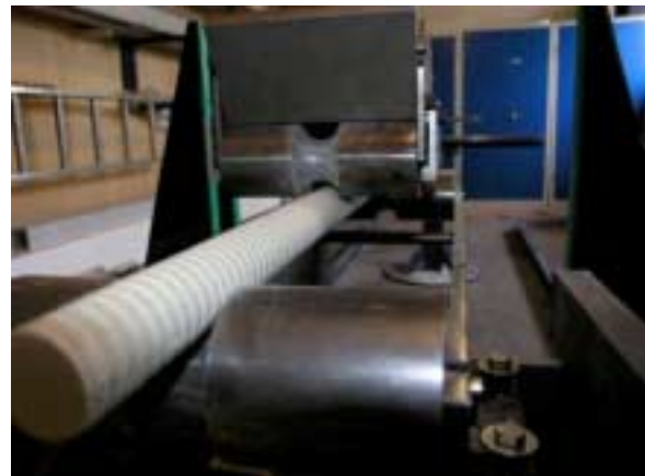
Abb. 21: von Fiberline entwickelte Vorrichtung zur Biegeprüfung der GFK-Stäbe
