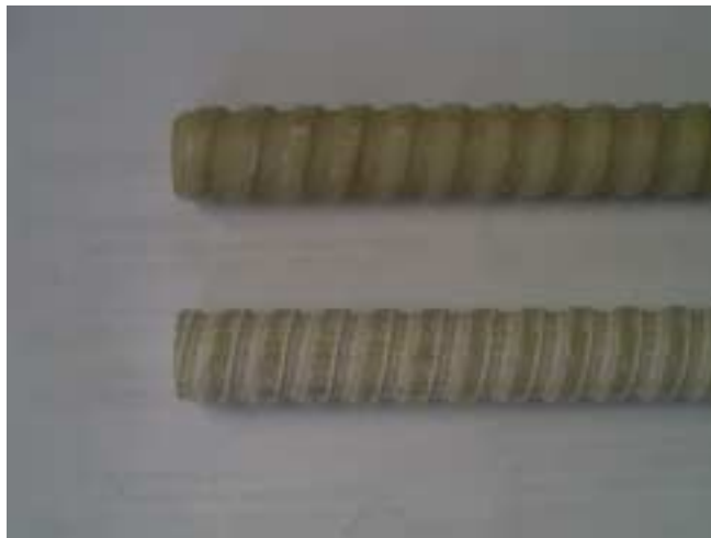
Abb. 6: nicht-ummantelter GFK-Stab (unten) im Vergleich dazu: profilierter GFK-Stab mit abschließender Harzbenetzung (oben)
