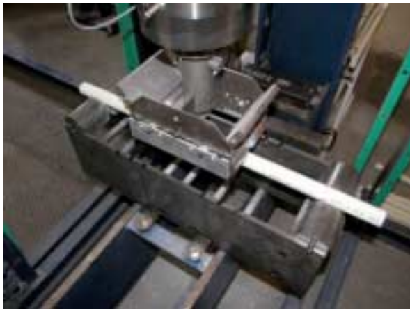
Abb. 21: von Fiberline entwickelte Vorrichtung zur Biegeprüfung der GFK-Stäbe
