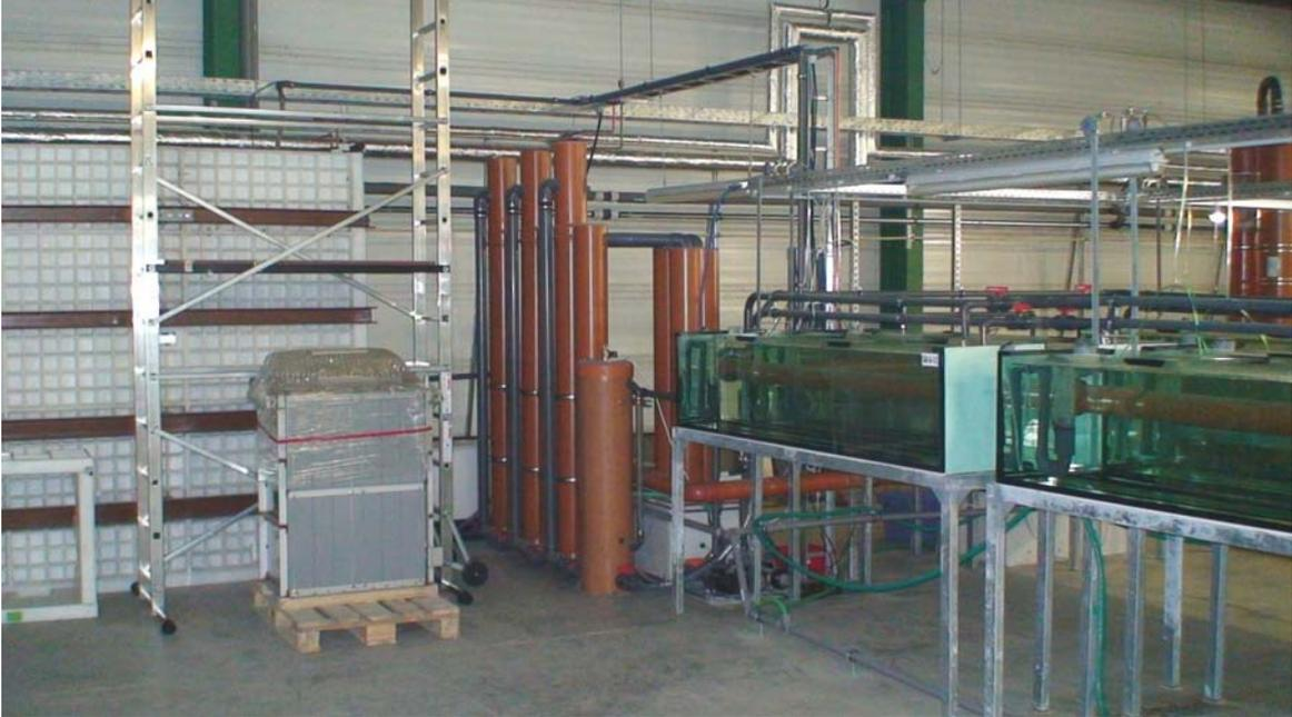
Glasanlage 6 (Verfahren Busse-MF mit Kubota-Membranen)
