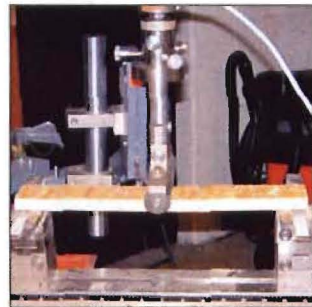
Biegetest mit OSB-Platte
