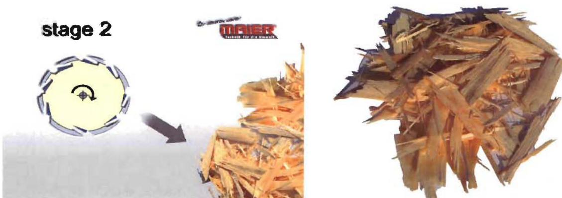
Abbildung 7 2. Stufe des OSB-Verfahrens - "Strands"
