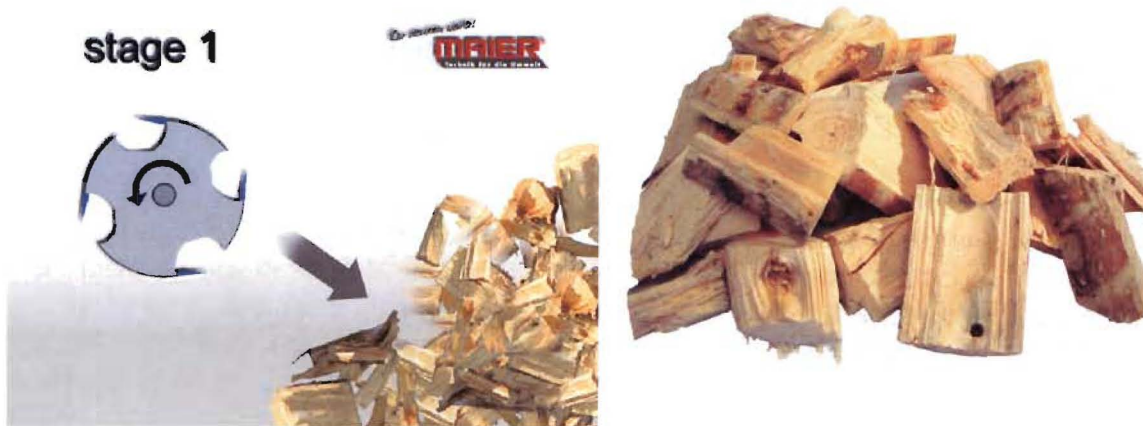
Abbildung 6 1. Stufe des OSB-Verfahrens "OSB-Chips" (Hackschnitzeln)
