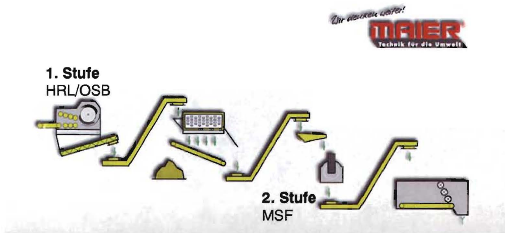
Abbildung 4 Flow-sheet Zweistufiges OSB-Verfahren
