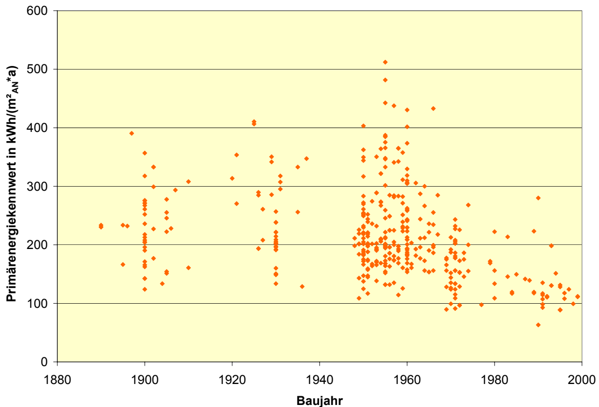
Abbildung 3-3: Primärenergiekennwerte aufgetragen über das Baujahr des Gebäudes
