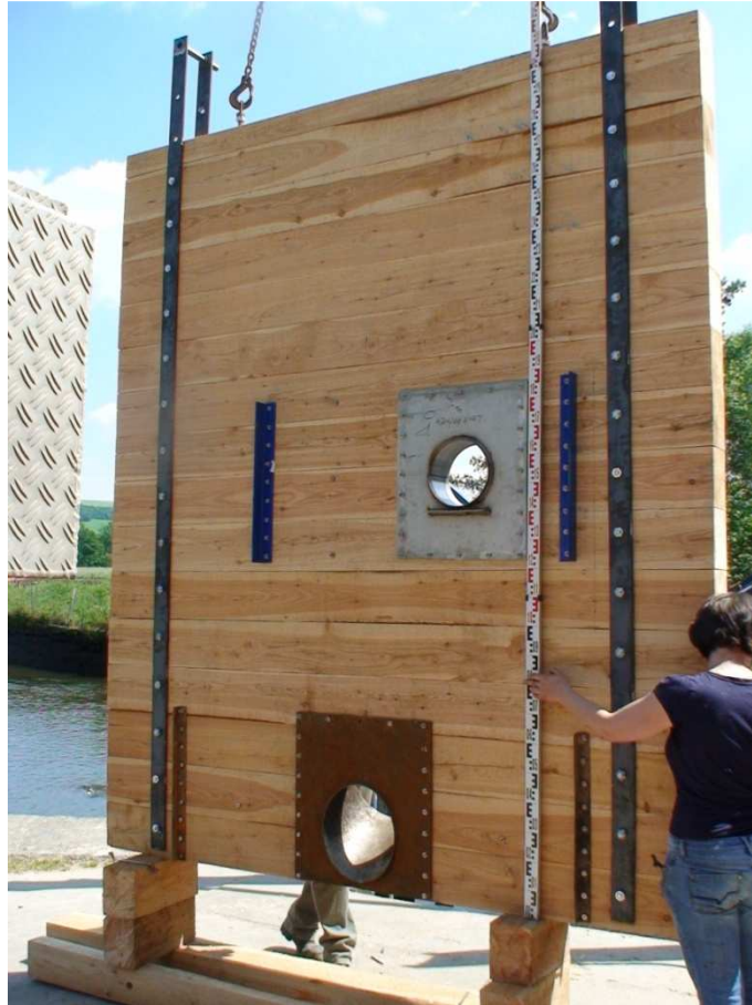
Foto 59: zur genaueren Untersuchung des Abstieges durch Bypässe wurde in das Leerschusschütz auch eine Öffnung in mittleren Wasserschichten integriert.
