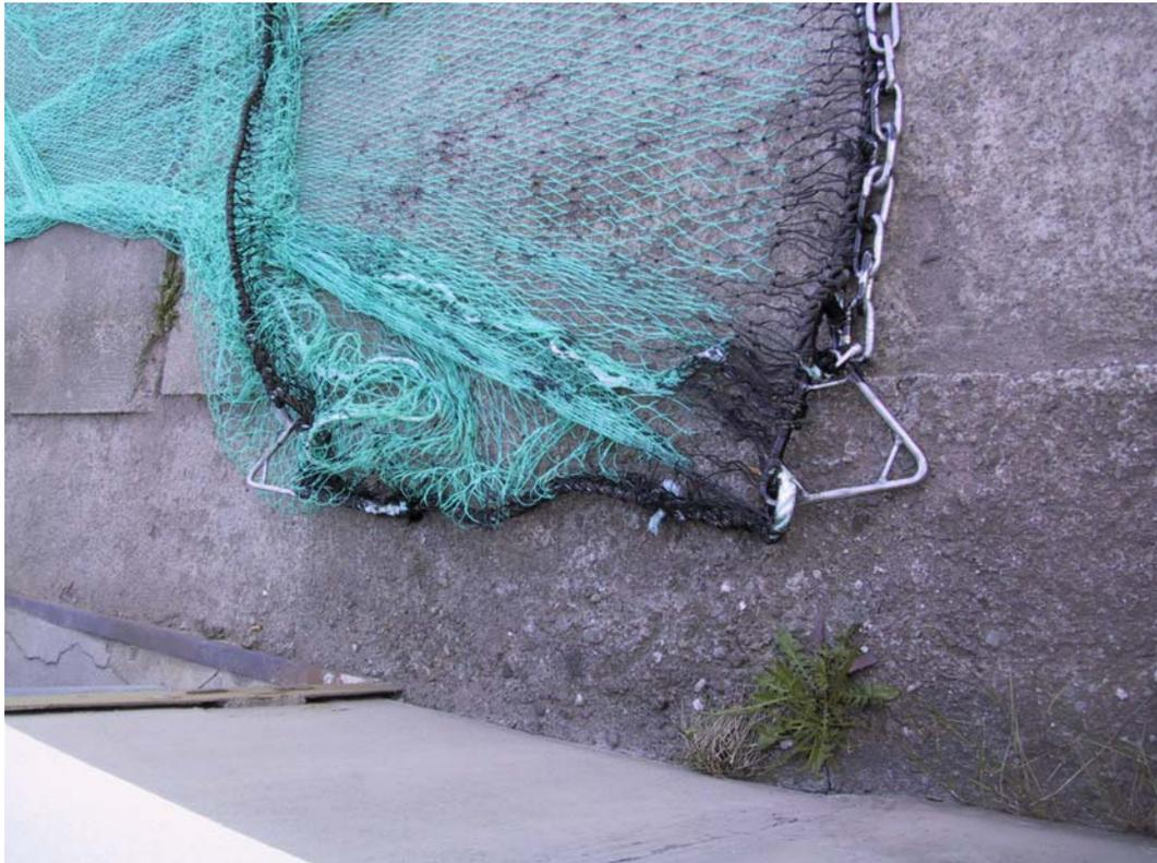
**Foto 19:** Detailansicht der Hamenöffnung mit Edelstahl-Dreiecken und Metallkette
