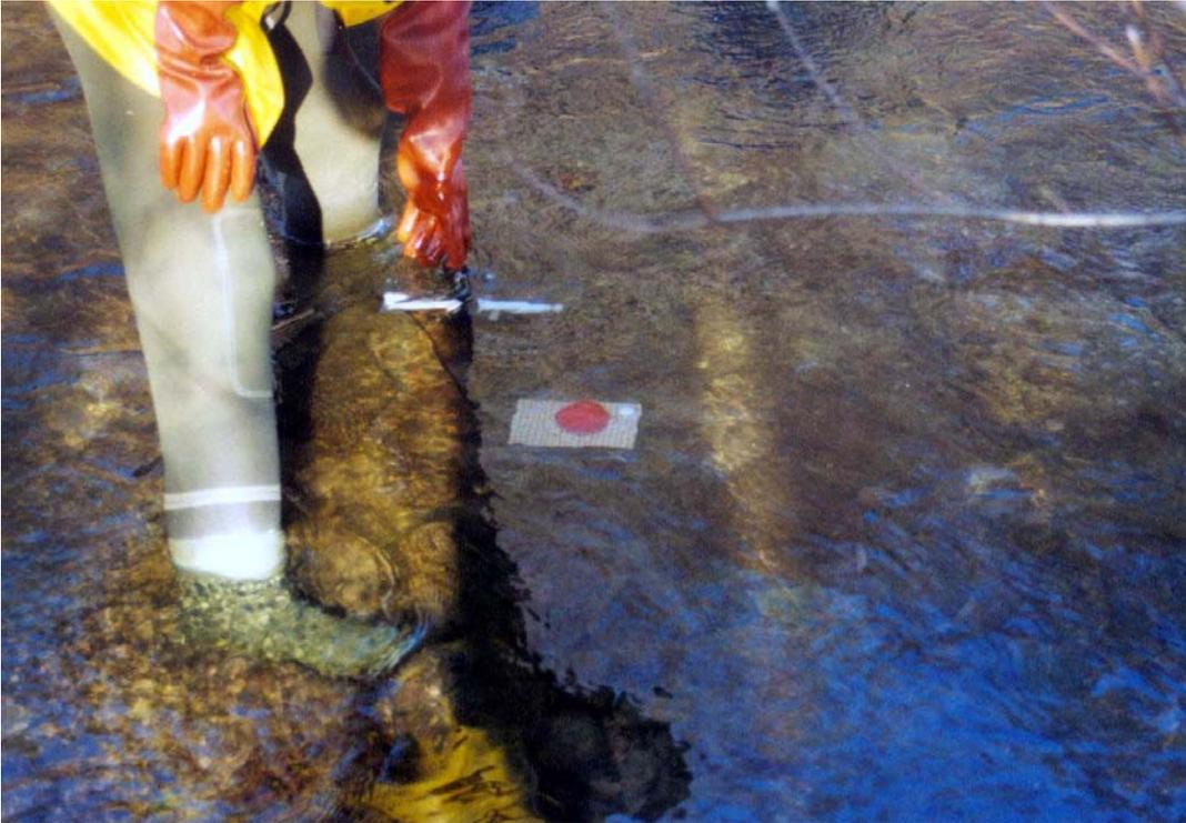
**Foto 13:** Messung der Sohlschubspannung mittels Halbkugelmethode im Mutterbett
