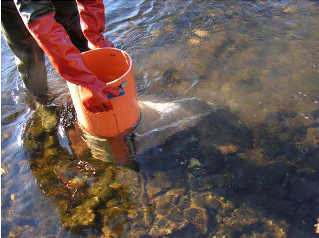
**Foto 15:** Makrozoobenthosprobenahme mit dem Hess-Sampler in der Referenzstrecke
