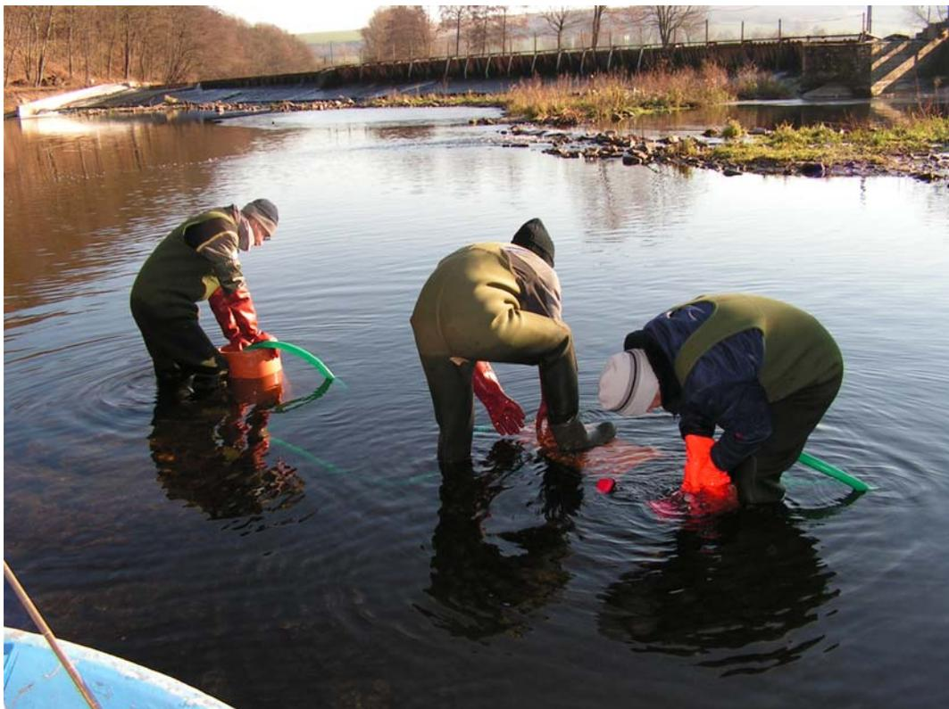
**Foto 16:** Makrozoobenthosprobenahme mit dem „Saug-Sampler“ im Mutterbett
