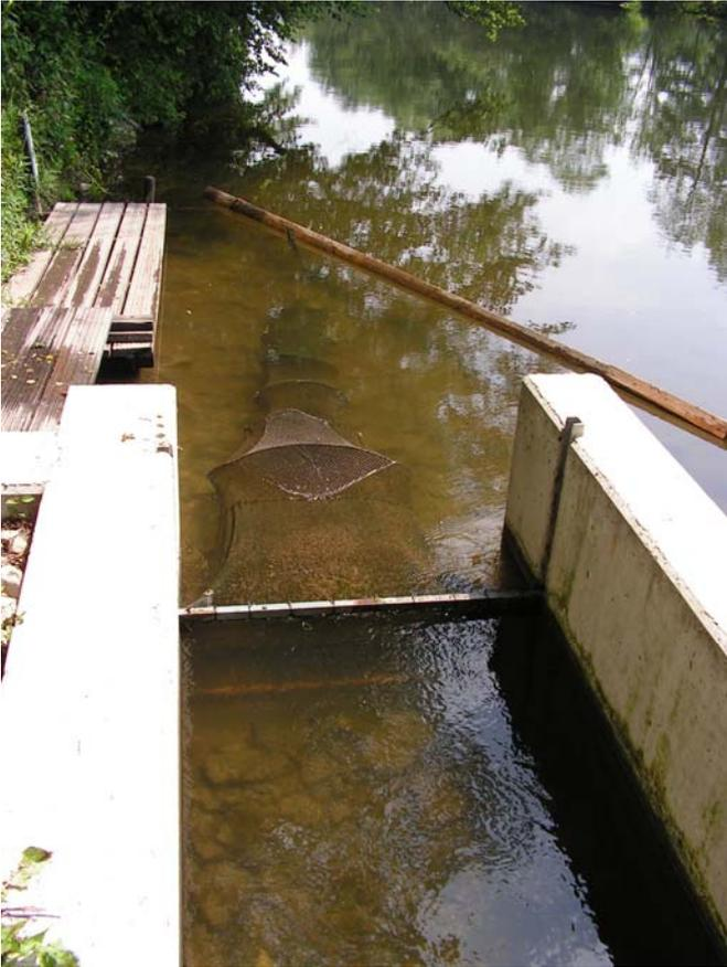
**Foto 52:** Aufstiegsreuse in den U-Profilen des Einlaufbauwerkes des FKP zur Aufstiegskontrolle 2006
