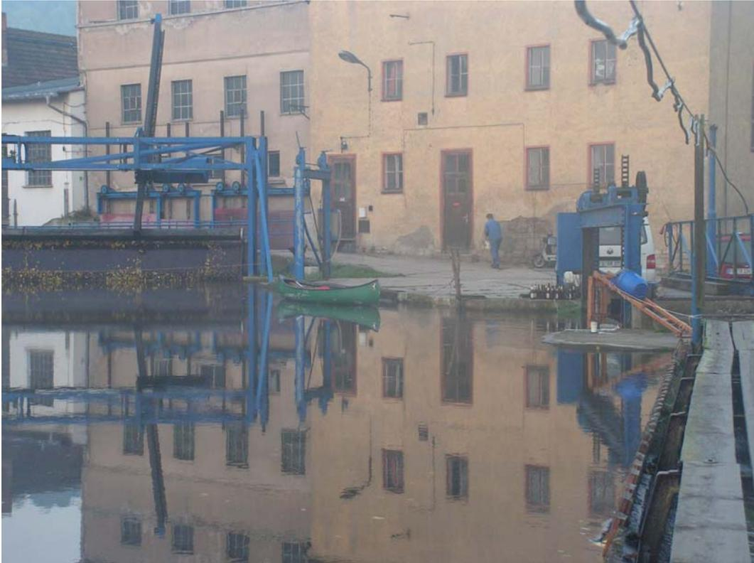
**Foto 35:** mit Fass beschwerte Halterung (rechts im Bild) des Splitbeamers – dieser zur ist Erfassung von Fischen vor dem Rechen auf die rechte Seite des Rechens ausgerichtet
