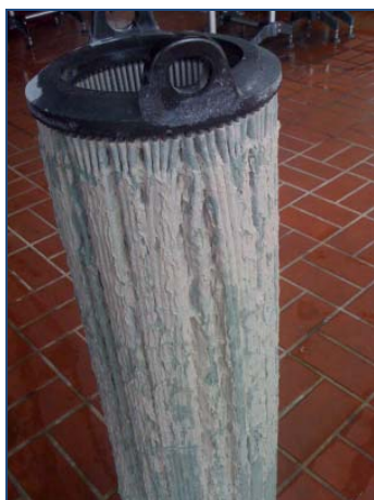
Bild 6: zugesetztes 3 µm-Filterelement nach 12.000 L Durchsatz
