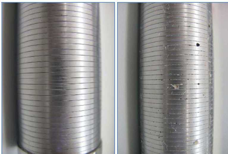
Bild 5: Spaltfilter 50 \mu\text{m} vor der Filtration (links) und nach der Filtration (rechts)
