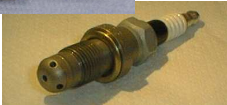
Bild 1.18: 4-Lochdüse und Vorkammerzündkerze für das BPI-Verfahren
