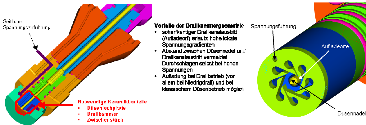
Bild 1.9: Vorbereitungen zur Applikation der elektrostatischen Aufladung
