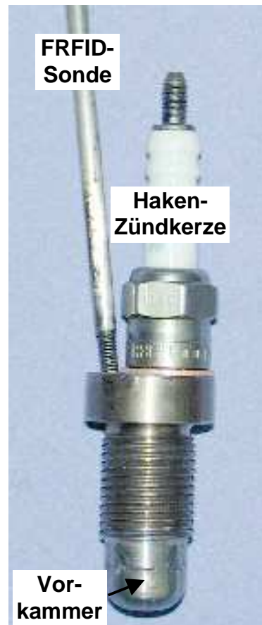
Bild 1.20: Vorkammerzündkerze mit FRFID-Sonde
