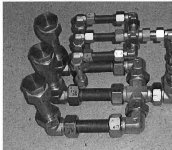
Abbildung 10: 3 x 2 Reaktor (liegend) für Hochdruckanwendung bis 60 bar / 300 °C im Heißluftofen
