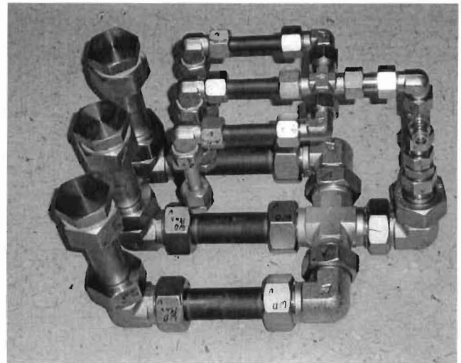
Abbildung 10: 3 x 2 Kalium-Reaktor (liegend) für Hochdruckanwendung bis 60 bar / 300 °C im Heißluftofen. Noch nicht eingesetzt.
