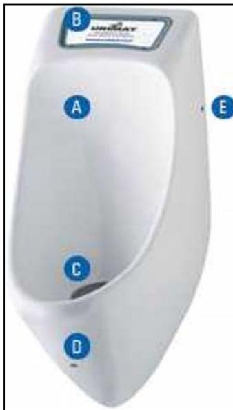
Der Geruchsverschluss erfolgt bei der Mehrzahl der angebotenen wasserlosen Urinale durch eine Sperrflüssigkeit, die leichter als Urin ist. Nach Herstellerangaben sind diese Flüssigkeiten (langkettige Alkoholverbindungen) biologisch abbaubar. Eigene Untersuchungen haben dies bestätigt. Andere Modelle arbeiten mit einem Magnetschwimmventil oder mit Gummimembranen als Geruchsverschluss.
