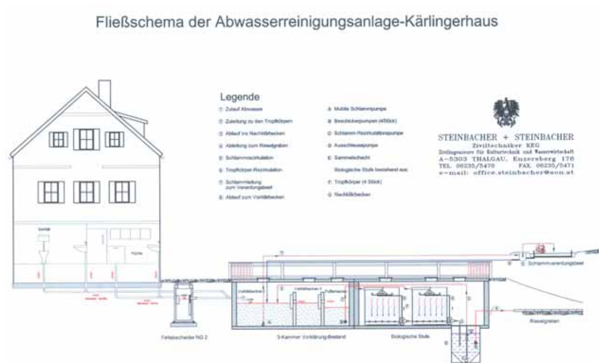
Abbildung 12: Fließschema der Abwasserreinigungsanlage Kärlingerhaus
